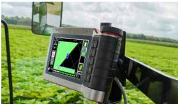
automatischer Teilbreitenschaltung sparen Sie Düngemittel, Pflanzenschutzmittel und auch Saatgut. Mit zwei Bildschirmen ausgestattet haben Sie mit dem IsoMatch Tellus PRO die Möglichkeit, zwei Maschinen oder Vorgänge gleichzeitig zu überwachen.
