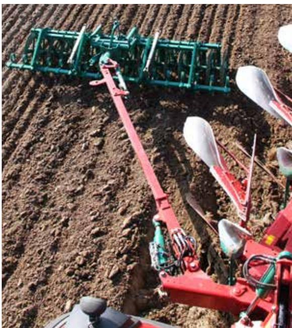
Der Packomat arbeitet unter allen Bedingungen. Er sorgt für Einebnung und Rückverfestigung, zerkleinert Kluten und bereitet das Saatbett, auf leichten bis hin zu schweren Böden, vor.
