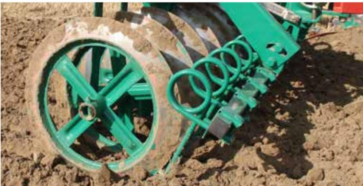
Frontstriegel: 16 mm mit Wechselspitze oder 20 mm mit Messern
