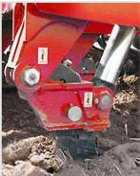
Der Pro-Lift Zinken ist beim DTX auch mit hydraulischer Steinsicherung verfügbar.
