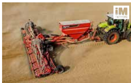
Pneumatický secí stroj DG II Vlajková loď DG II zvládne až 140 ha za den. Systém "Active on" napomáhá správnému dotížení výsevních btek do půdy. Vybaveno elektricky poháněným dávkovacím systémem ELDOS.
