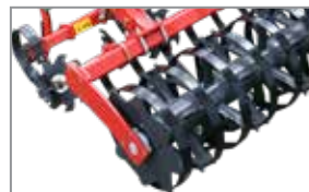
Actiflex ø 580 mm - 160 kg/m
