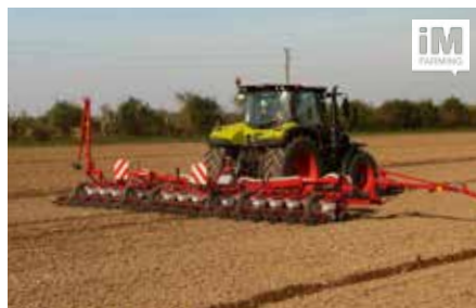
Unicorn PH (6m a 9m) Snadná přeměna z transportní do pracovní polohy. Transportní šířka u všech modelů je max. 3,0 m.
