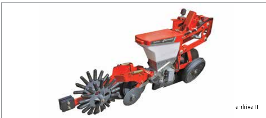
Unicorn řádek Optimální hloubkové vedení je předpokladem pro přesné setí. Setí v řádku pomocí Unicorn lze použít pro konvenční setí, ale také pro setí bez jakýchkoliv modifikací. Kromě cukrové řepy lze Unicorn použít také k setí řepky a čekanky.
