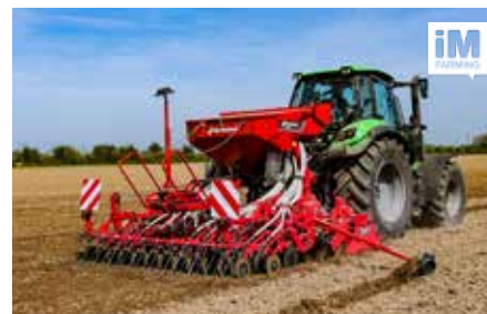
Pneumatický secí stroj s-drill Težší verze secího stroje DA. Secí stroj S-drill je vhodnější pro větší farmy.
