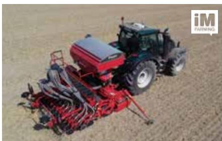
Pneumatický secí stroj e-drill maxi plus Setí a hnojení v jednom přejezdu. E-drill maxi plus se zásobníkem max. 2100 litrů s nastavitelným poměrem 60:40, 70:30 nebo 100:0. Jsou zde umístěny dvě výsevní jednotky ELDOS.
