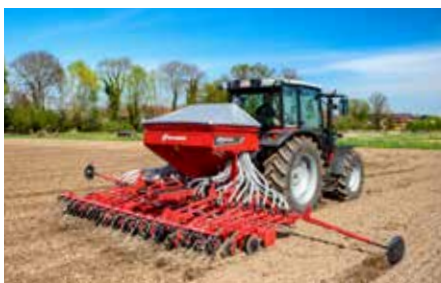
Pneumatický secí stroj DL Kompaktní - DL je ideální stroj pro malé a střední farmy.
