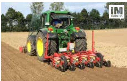
Unicorn pevný (3m, 6m, 9m a 12m) Pro malé a střední pole. Od 6 m k dispozici s podélnou přepravou. Vybaveno 6 až 24 řádky.
