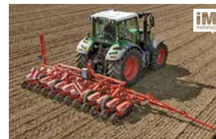
Monopill PH (6m a 9m) Pohodlné a časově úsporné paralelně hydraulické skládání zajišťuje přepravní šířku max. 3,0m.
