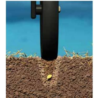
La roue plombée affermit le sol autour des graines, optimise le contact entre les semences et le sol et crée les conditions idéales pour la germination, ce qui entraîne une levée constante.
