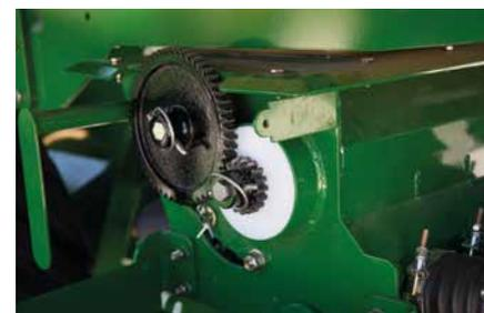
Le doseur est repensé afin de supprimer toutes les « zones mortes » dans lesquelles les graines s'accumulent. Un agitateur standard garantit que même la plus légère des graines est nourrie équitablement et de façon constante.
