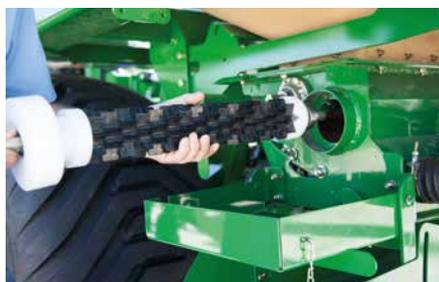
Tous les modèles Spartan II proposent un choix de trois cylindres à cannelures afin de permettre des tailles de graines très variées. Il est facile et rapide de changer le cylindre à cannelures. Le système est capable de semer à raison de 325 kg/ha à 14 km/h.
