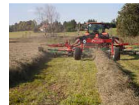
Two swath raking (Vario).
