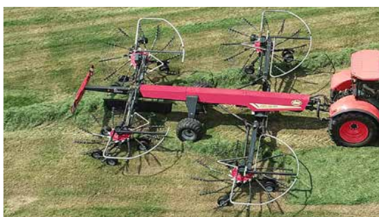
Vicon Andex 1304 Pro Individueel heffen van alle vier de rotoren.
