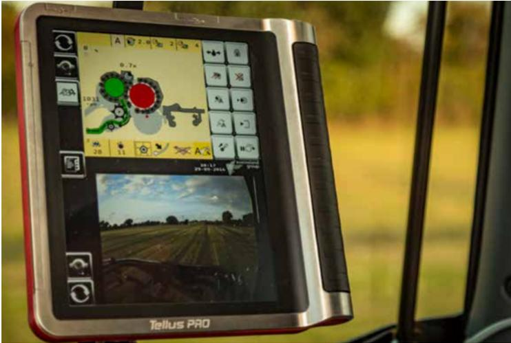
Una cámara de visión trasera 'IsoMatch Eye' combinada con el terminal Tellus Pro de gran pantalla permite al operador controlar el proceso de encintado y la descarga segura de las balas.
