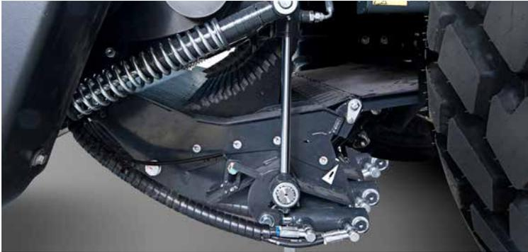
El sistema de corte SuperCut de 25 cuchillas ofrece la posibilidad de elegir entre 6, 12, 13 y 25 cuchillas para todas las condiciones. Todo ello con la seguridad de un fondo de caída en caso de bloqueo.
