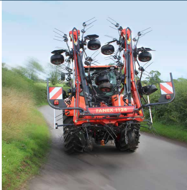
Dimensions de transport compactes de la Fanex 1124 - hauteur de stockage de seulement 3,80 m.
