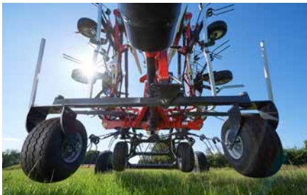
Nouvelle roue de jauge en option avec roue double pour une grande précision dans le suivi au sol.
