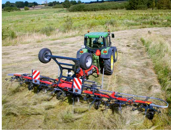
Tirez le meilleur parti de votre récolte. Avec la mise en oblique, vous gardez la récolte à l'intérieur du champ. La faneuse est positionnée hydrauliquement dans la position mise en oblique, facilement, pour éloigner la récolte des bordures de champ.
