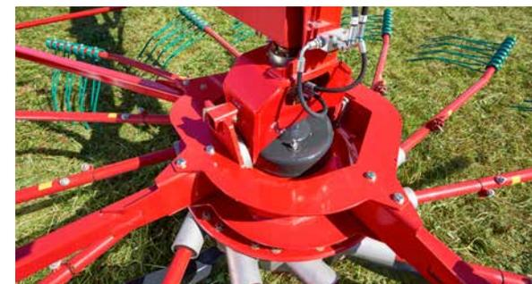
La hauteur de travail de chaque rotor peut être réglée indépendamment et hydrauliquement.
