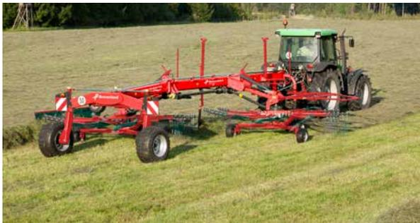
Une planche à andain repliable hydrauliquement est disponible en option sur le 9577 S.
