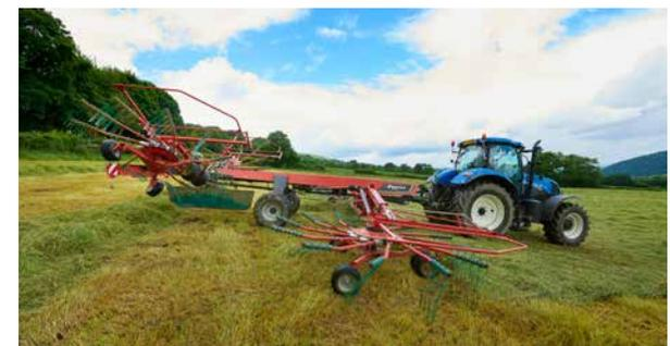
Relevage individuel des rotors avant et arrière. La temporisation réglable pour la position en fourrière est standard.
