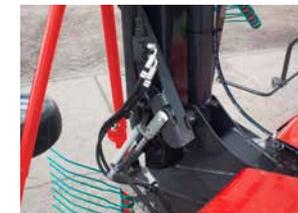
Verrouillage hydraulique au transport (option).
