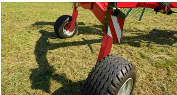
Une direction active des roues pour une meilleure maniabilité en combinaison avec de grandes roues pour réduire le compactage.
