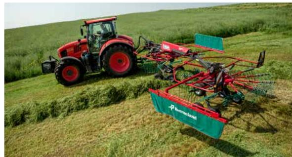
Les andaineurs Kverneland sont équipés en standard du système QuickLift. Il permet de relever l'appareil de 50 cm afin de franchir facilement le fourrage déjà andainé.
