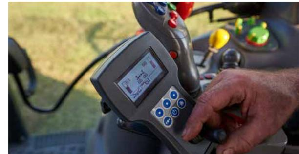
Le kit confort inclut le contrôle électrique de la hauteur de chaque rotor.
