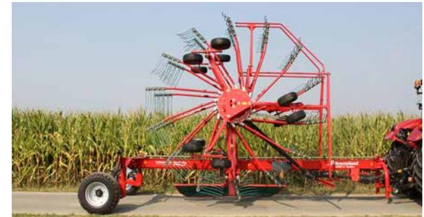
Avec une largeur de travail de 9,00m et une hauteur de transport inférieure à 4m, même sans détacher les bras...
