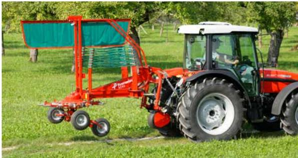
Pour le transport ou le remisage, les garants de protection latéraux se replient le long du châssis. Un ressort d'assistance favorise le repliage de la planche à andain pour minimiser les efforts de l'utilisateur.
