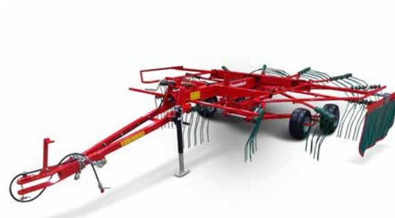
Kverneland 9447 T avec une largeur de travail de 4,70 m et un poids de seulement 665 kg.
