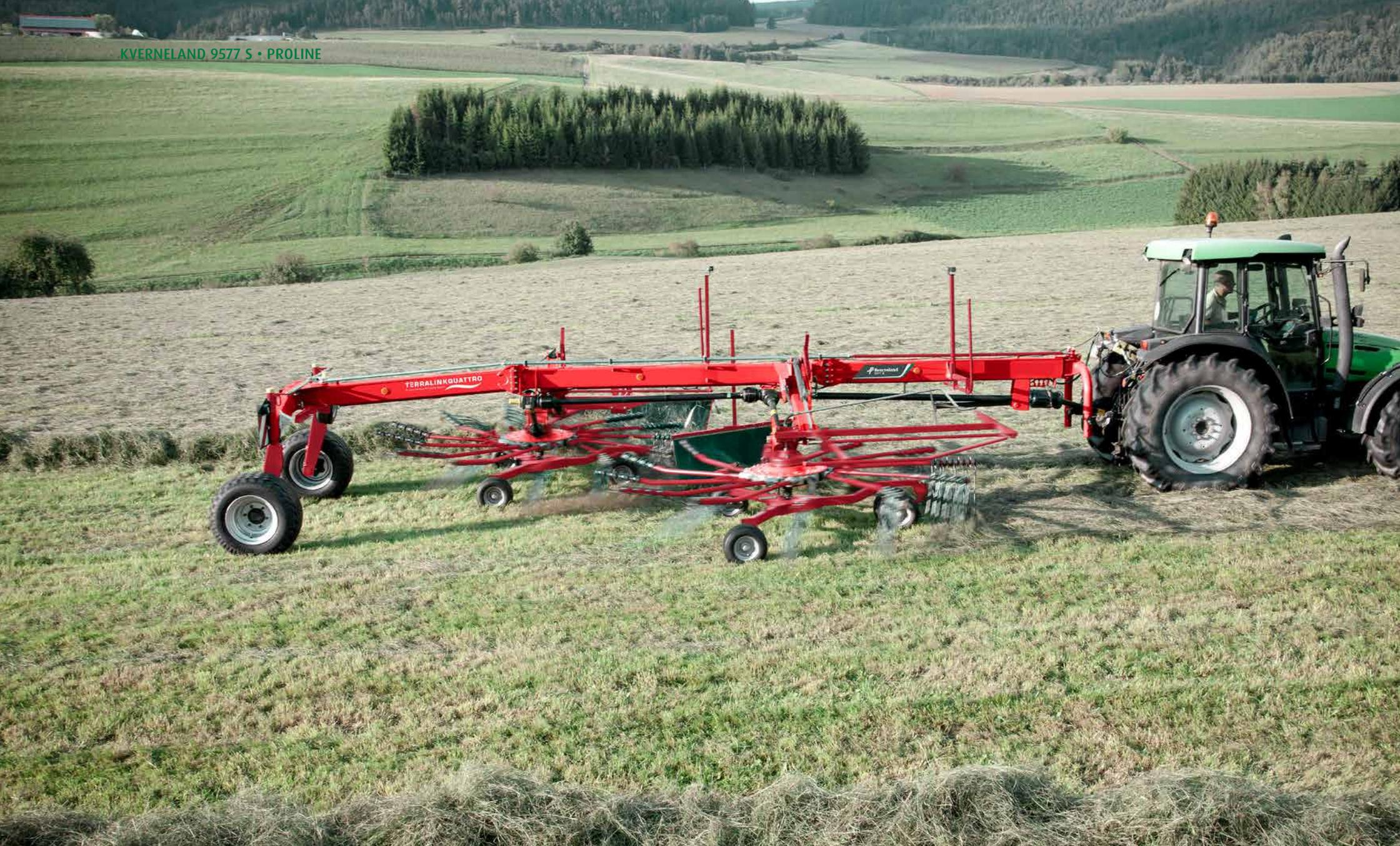
La position un andain latéral permet de rapprocher jusqu'à 15m de foin en travaillant en aller-retour.
