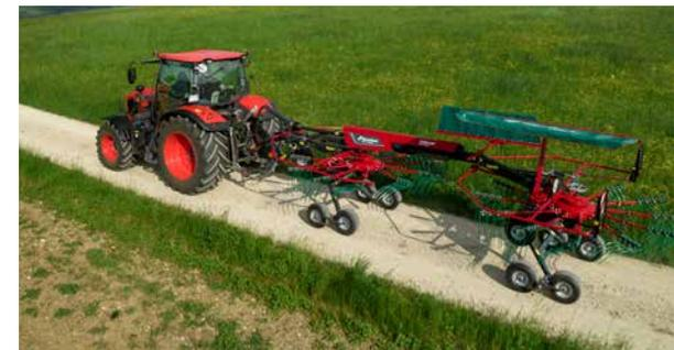
L'essieu arrière suspendu permet un excellent confort de conduite et diminue la puissance nécessaire
