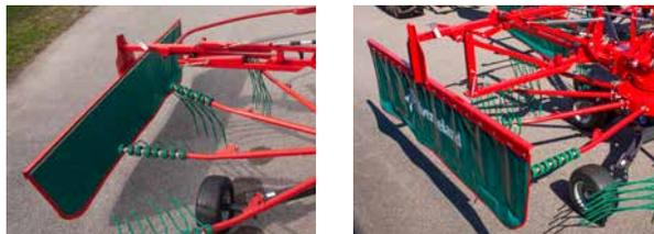
Repliage automatique de la planche à andains et béquille de stationnement.
