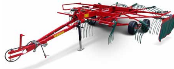
Kverneland 9447 T с шириной захвата 4,70 м и весом 665 кг.
