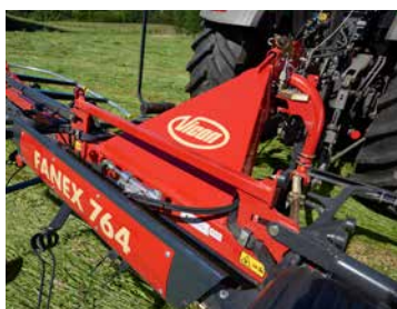
Sterk en robuust hoofdframe met V-vormige aanbouwboek.
