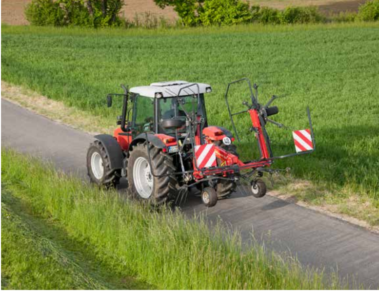
Alle schudders zijn hydraulisch opklapbaar van werk naar transportstand en omgekeerd.
