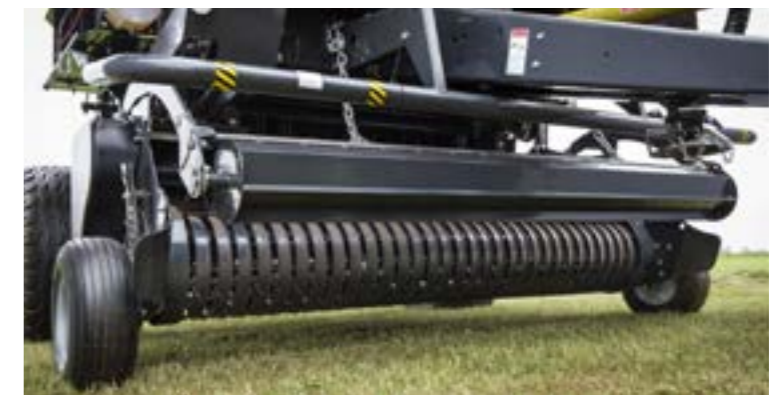
A nagy átmérőjű hengeres terményleszorító elősegíti a terményáramlást nagy behordási sebességénél.
