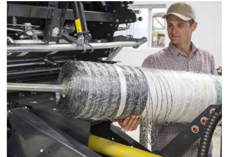
A rendkívül alacsony rakodási magasság és az igazán egyszerű háló befűzés minimális állásidőt és maximális bálázási időt eredményez.
