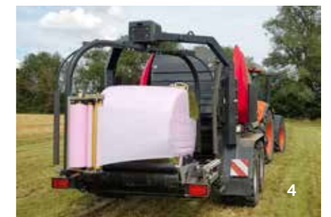
4 A csomagolóasztal gyorsan elmozdul a fóliafeszítők irányába és a csomagolás azonnal kezdődik.
