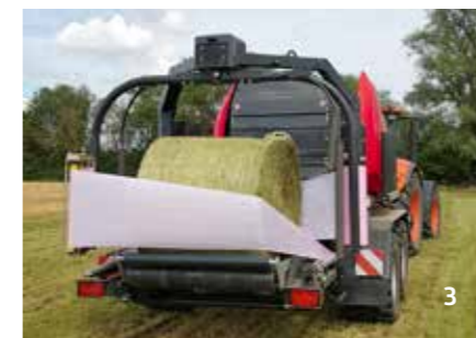
3 Amint a bála továbbítódik a bálázótól, a kamraajtó azonnal becsukódik és a bálázás újraindul.
