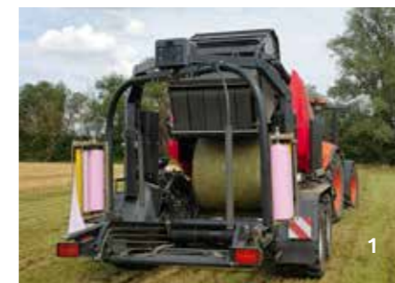
1 Miután a háló felkerült a bálára, a csomagolóasztal a kamraajtó alá mozdul el.
