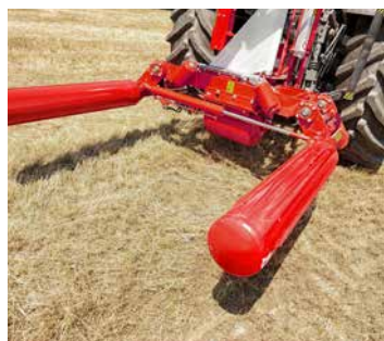
Facile e delicato autocaricamento delle balle - la palla è sollevata dai rulli.
