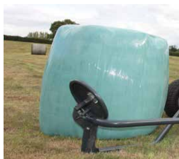
Il Vicon BW2850 può montare un kit per il ribaltamento della palla allo scarico.
