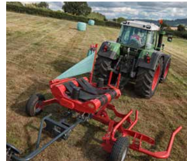
Piattaforma con due rulli a rotazione attiva pensati per la massima stabilità della balla e rotazione regolare e uniforme.
