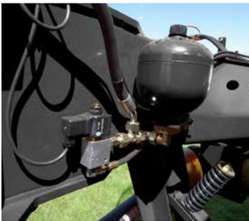
Sospensioni idrauliche per una regolazione della pressione al suolo molto precisa (modello EXTRA 440H).
