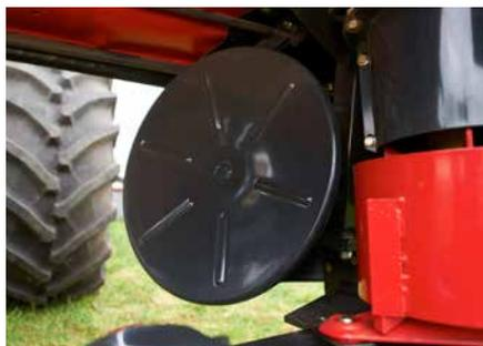
La macchina è provvista standard di due dischi andanatori, in grado di formare un'andana da 2.20 a 2.40 m.
