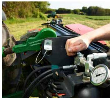
Regolazione idraulica della pressione (modelli EXTRA 428H e 432H).
