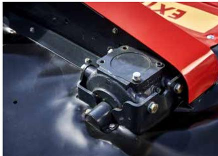
**3.** Possibilità di scegliere la trasmissione in senso orario o antiorario, adattabile a qualsiasi trattore.
