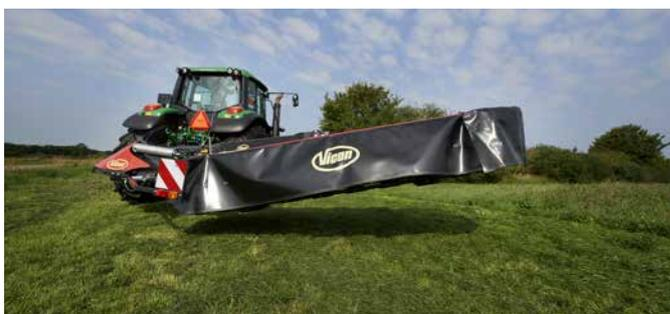
Semplice sollevamento a fine campo tramite cilindro idraulico, con ampia luce da terra.
