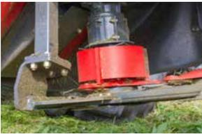
Trasmissione diretta dalla scatola di trasmissione al primo disco.
