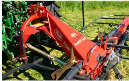
Il design rinforzato del telaio centrale a V fornisce stabilità sia durante lo spandimento, sia durante il trasporto.
