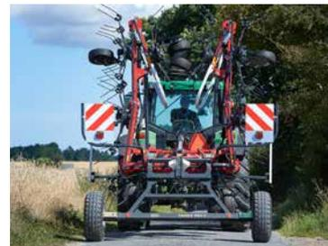
Il carrello di trasporto del Fanex 904C è dotato di ruote da 10.0/75 - 15.3 con un'interasse di 2,45 m.
