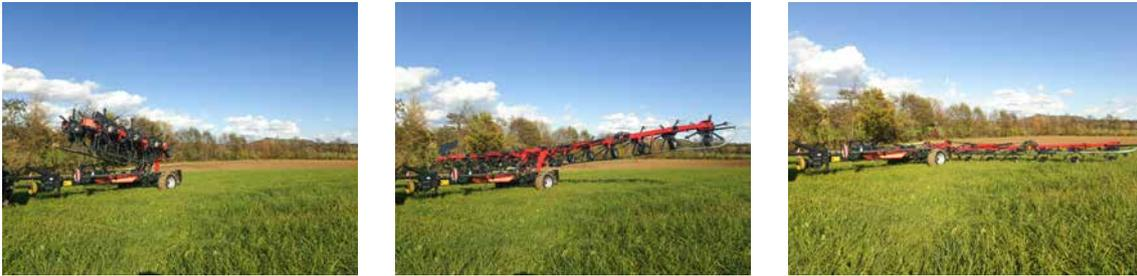
Fanex 1564C si dispiega facilmente in tre fasi. Si solleva con la valvola a semplice effetto dalle staffe di trasporto. In secondo luogo, viene dispiegato in posizione a fine campo tramite l'uscita a doppio effetto. Infine, viene abbassato tramite la valvola a semplice effetto in posizione di galleggiamento.
