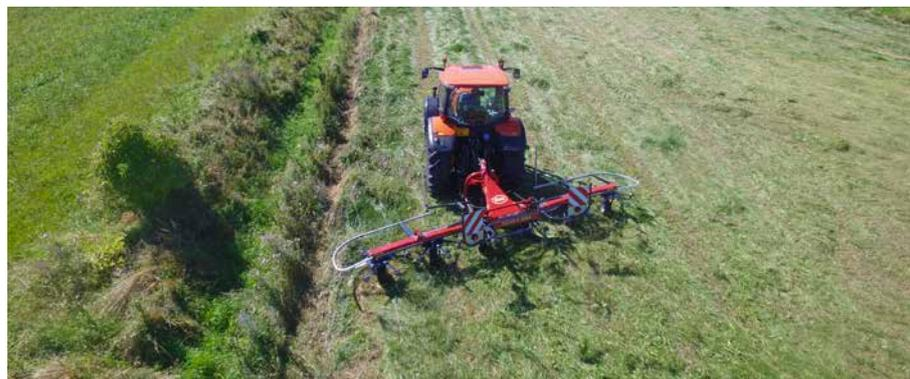
Per aumentare la produttività, questi volatieni sono dotati di dispositivo di spandimento in bordura meccanico. La soluzione idraulica è disponibile a richiesta. Un indicatore permette di individuare la posizione rispetto all'asse.
