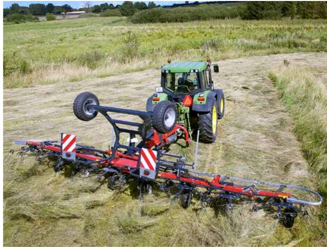
Ottieni il massimo. Con il dispositivo di spandimento in bordura il prodotto è mantenuto all'interno del campo. Il voltafieno è idraulicamente posizionato per allontanare agilmente il foraggio dal limite esterno dell'appezzamento.
