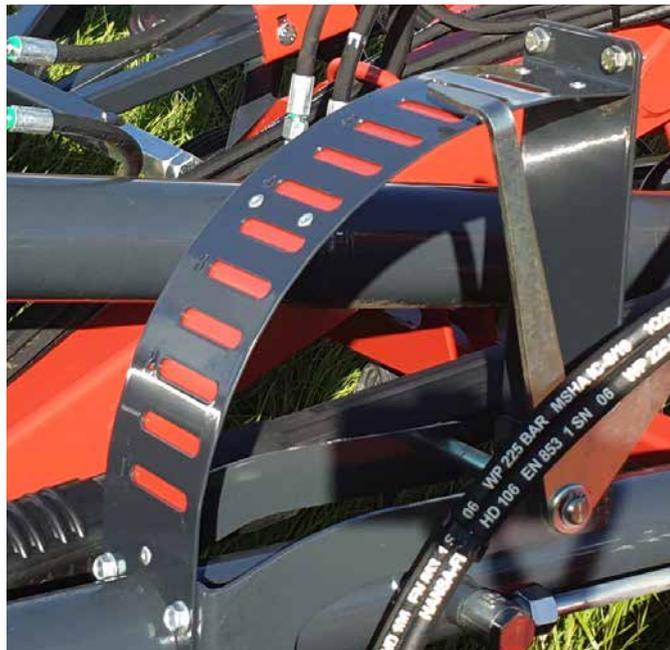
In opzione è disponibile la regolazione idraulica dell'altezza, controllata con una valvola supplementare a doppio effetto. La scala è facilmente leggibile dalla cabina, semplificando la corretta regolazione della macchina.
