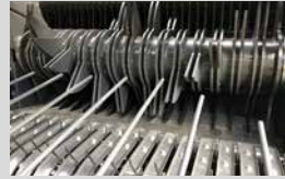
Rotor d'alimentation 15 % plus grand avec système de coupe SuperCut à 15 couteaux
