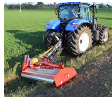
Bis zu – 65 Grad zur Graben und Böschungspflege.
