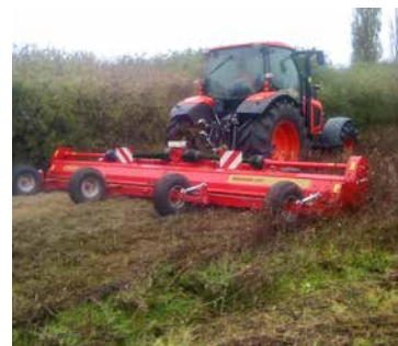
Wahlweise sorgen eine Stützwalze mit 245 mm Durchmesser oder vier schwenkbare Stützräder für eine sichere Tiefenführung.
