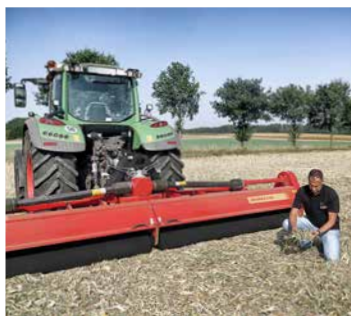
Zur einfachen Wartung und besseren Zugänglichkeit können die Mulcherhauben geöffnet werden.
