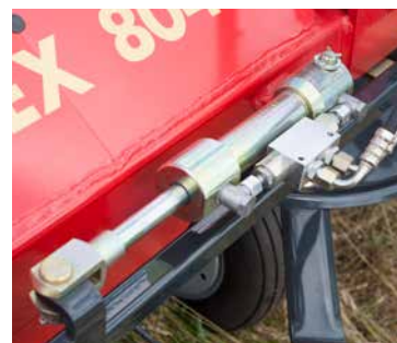
Optionale hydraulische Grenzstreuungrichtung
