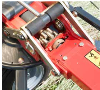
HexaLink-Fingerkupplung zum Klappen der Kreisel um 180°.
