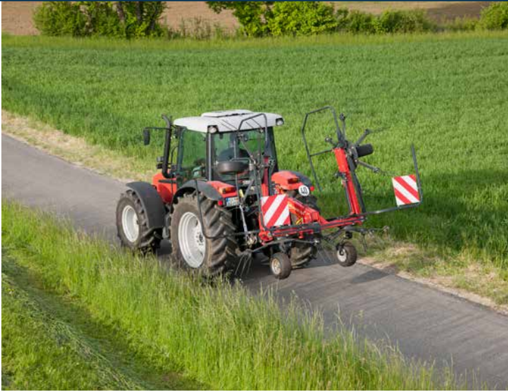
Die Kreiselzettwender werden hydraulisch von der Arbeits- in die Transportposition und umgekehrt geklappt.
