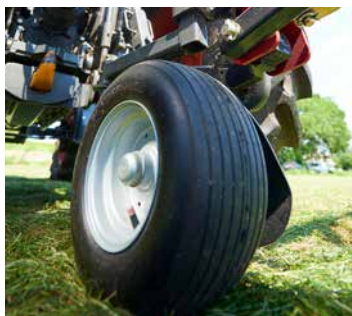
Stützrad für perfekte Höhenführung (Option)
