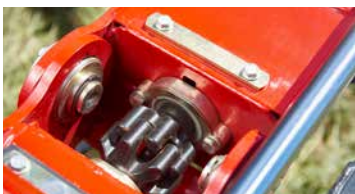
Die Vicon HexaLink-Kupplung an den äußeren Kreiseln erlaubt eine kompakte Transportklappung beim Fanex 764, 904 und 1124 (C).
