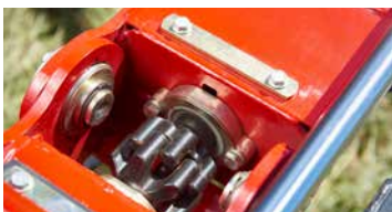
Die Vicon HexaLink Kupplung an den äußeren Kreiseln erlaubt eine kompakte Transportklappung bei Fanex 764, 904 und 1124 (C).
