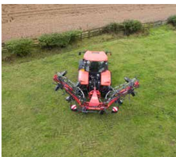
Klappmechanismus – mit gleichmäßiger Gewichtsverteilung während des gesamten Klappvorgangs
