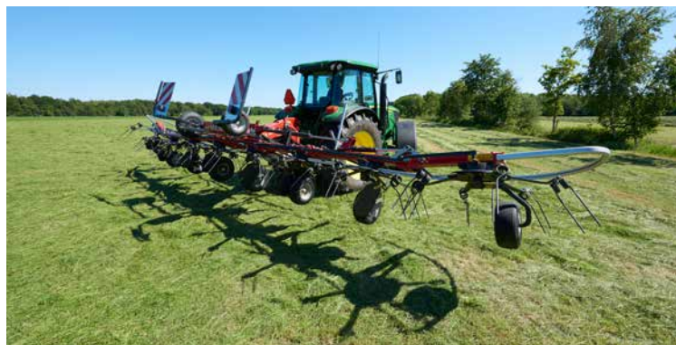
Alle Fanex-Zettwender für Dreipunktanbau können mit dem hydraulischen Vorgewendese (Option) ausgerüstet werden, das die äußeren Kreisel aushebt.
