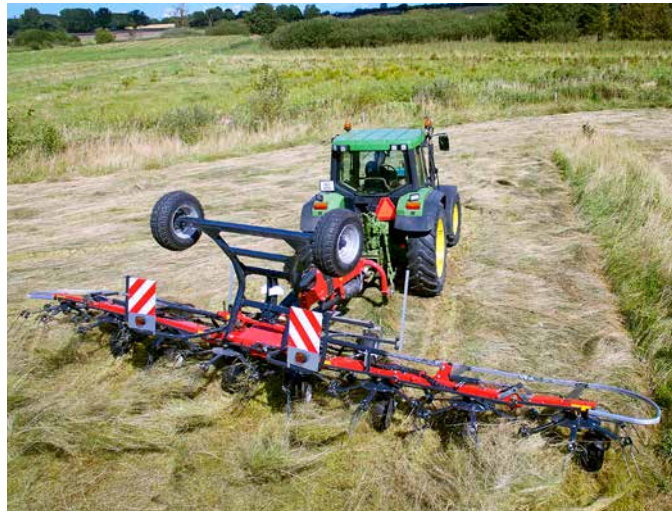
Für die Vicon Fanex Serie gibt es eine hydraulische Grenzstreuung. Futterverluste an Feldrändern werden dadurch vermieden.
