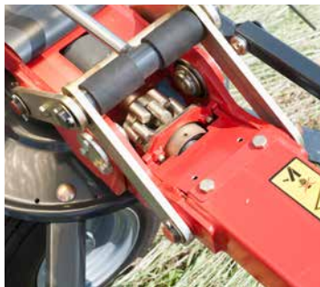
HexaLink Fingerkupplung zum Klappen der Kreisel um 180°
