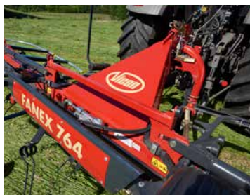
Starker und robuster V-förmiger Hauptrahmen
