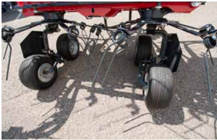
Optionale Tandemachse für die beiden mittleren Kreisel
