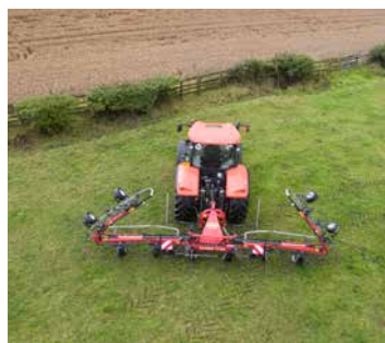
Klappmechanismus – mit gleichmäßiger Gewichtsverteilung während des gesamten Klappvorgangs
