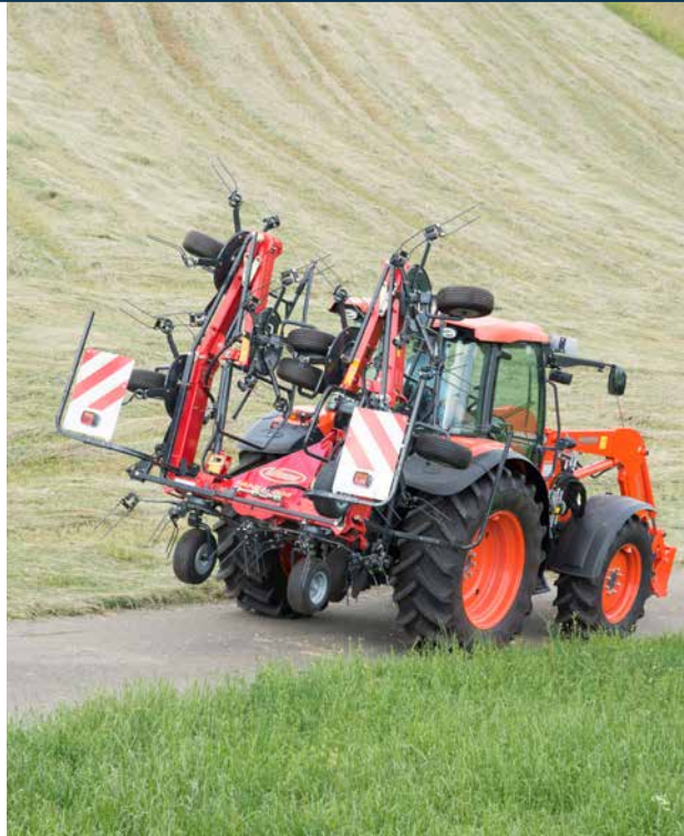
Der Fanex 804 wird in eine sehr kompakte Transportposition geklappt.
