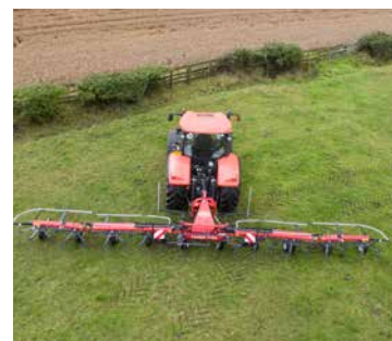
Klappmechanismus – mit gleichmäßiger Gewichtsverteilung während des gesamten Klappvorgangs
