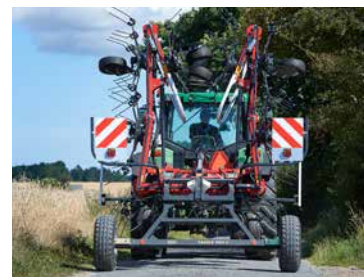
Das Transportfahrwerk ist mit einer groß dimensionierten Bereifung 10,0/75 – 15,3“ ausgestattet.
