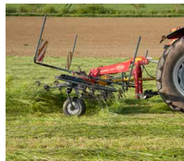
Während der hydraulischen Klappung für den Transport, werden die Zinken automatisch angehoben.
