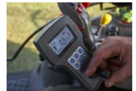
ComfortKit, elektronikusan állítható a rotorok magassága, külön-külön.
