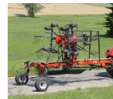
A szállítási magasság további korlátozása érdekében a villakarok levehetőek az Andex 764-en. A rendterelő automatikusan felcsukódik.
