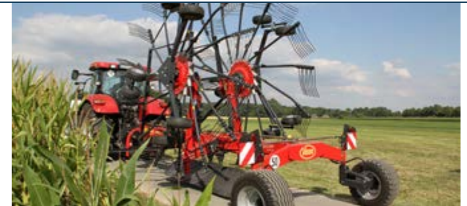
9.00m munkaszélességgel és 4m alatti szállítási magassággal, a villatartó karok leszerelése nélkül...
