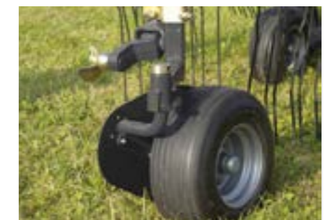
Opcióban rendelhető támasztó kerék a harmadik ponthoz, növelve a talajkövetés biztonságát.
