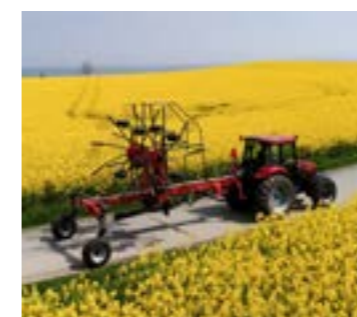
A Vicon közép rendképzőket hidraulikusan állítjuk munka helyzetből szállítási helyzetbe.
