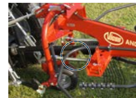
Az oszcilláló lengéscsillapítók biztosítják a megfelelő traktor követést.
