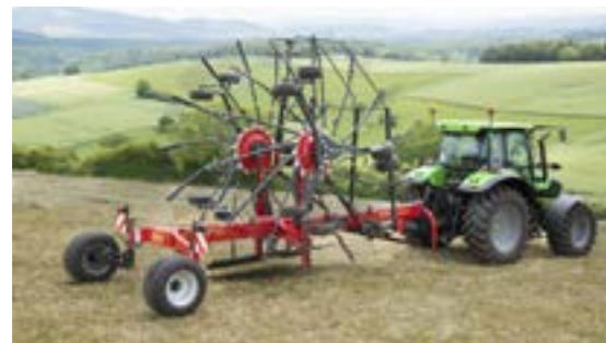
Vicon Andex 1254 Hidraulikusan leengedhető, magasság 4 m alatt.
