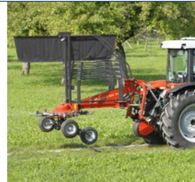
Szállítás vagy tárolás céljából a rotor védőkereteit felhajthatjuk a váz fölé, amik automatikusan reteszeldnek a helyükön. A rendterelő ponyvához kapcsolt segédrugó csökkenti a szükséges emelőerőt.
