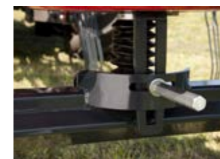
A fokozatmentesen állítható vezérlőpálya lehetővé teszi a finomhangolást, hogy az adott körülmények szerinti optimális rend legyen kialakítva.
