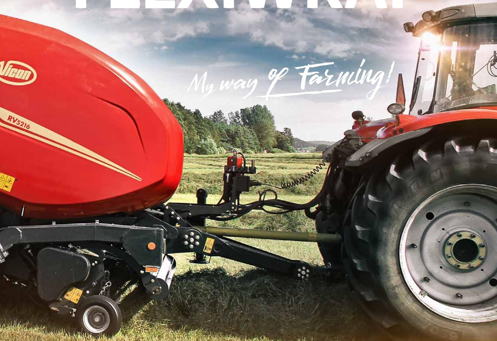
Los modelos de la serie FlexiWrap RV 5000 proporcionan una solución versátil de empacado y encintado. Con su capacidad para hacerlo todo, desde hacer pacas de 1,25 m de diámetro en condiciones de ensilado húmedo hasta hacer pacas de más de 2 m de diámetro\* con paja seca, el modelo Vicon FlexiWrap le da la oportunidad de hacerlo todo.
