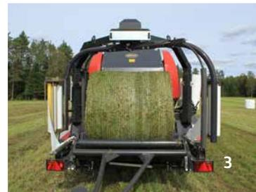
Tan pronto como la paca se transfiere fuera de la empacadora, la compuerta trasera se cierra automáticamente y se puede reanudar el empacado.
