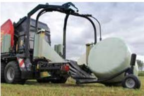
Opción de volteo de la paca. Durante el transporte, el kit se gira automáticamente en una posición de seguridad.
