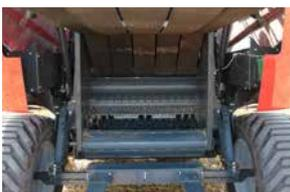
Un juego de 5 correas y 3 rodillos permite obtener pacas densas con un núcleo blando y un fácil arranque de la paca.
