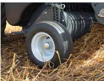
Ruedas de apoyo con ajuste de altura del pick-up.
