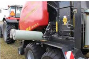
El almacenamiento de film estirable se baja hidráulicamente para facilitar el cambio.
