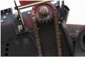
La transmisión de la cámara principal es una cadena reforzada de 1" 1/4 para aumentar la durabilidad y reducir el mantenimiento.
