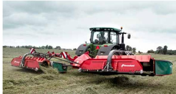
Cuando se utiliza una sola cinta, la velocidad se reduce para evitar que el cultivo se coloque demasiado lejos del centro.
