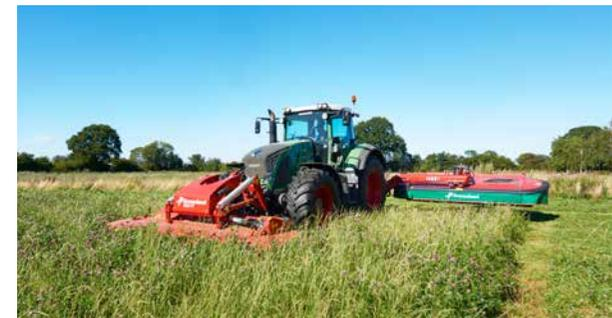
En condiciones de cosecha corta, se puede reducir la altura de elevación de las unidades de corte para aumentar la velocidad en las cabeceras.
