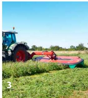
1. Distancia al suelo de 500 mm sobre toda la unidad de corte al girar en la cabecera. La unidad de corte se eleva y el brazo de apoyo se inclina en un ángulo de 10°.
