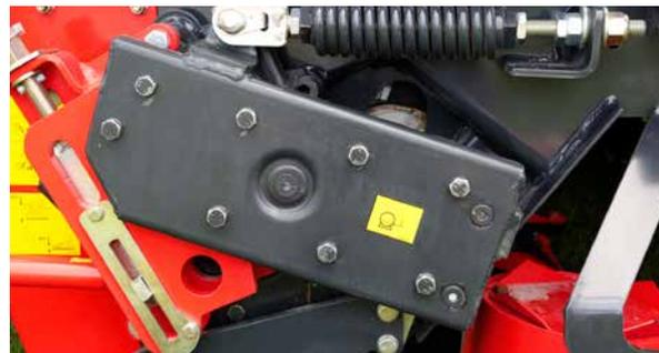
Los 2 rodillos acondicionadores son accionados a cada lado con carcasas lubricadas de bajo mantenimiento.
