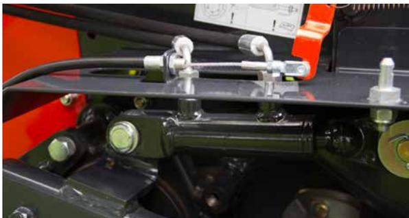
Con el cilindro hidráulico opcional, la presión y la distancia entre los rodillos se pueden ajustar fácilmente.
