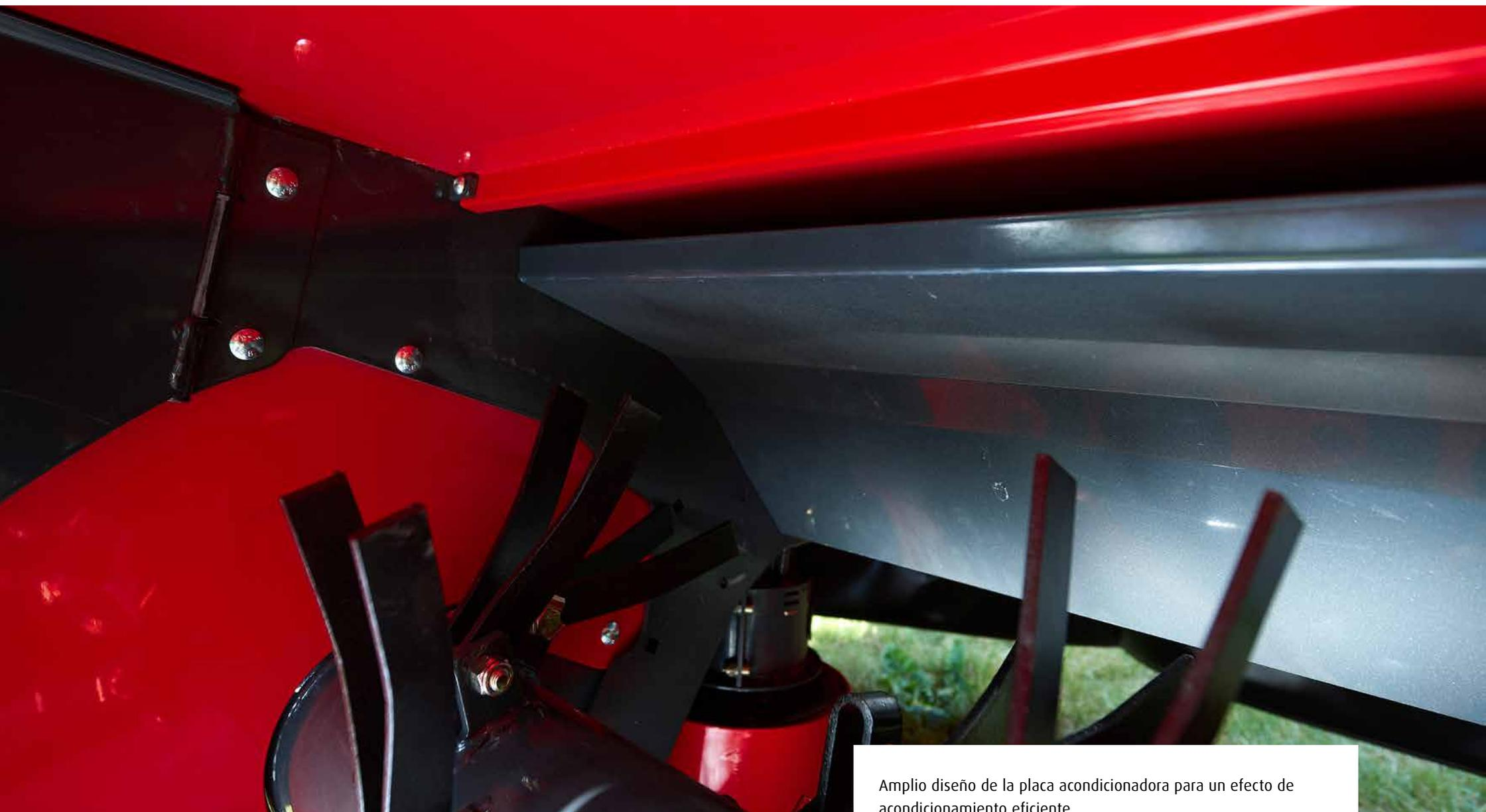
Amplio diseño de la placa acondicionadora para un efecto de acondicionamiento eficiente.
