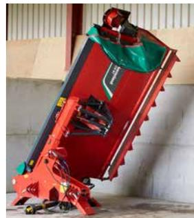
Los brazos de elevación están siempre en posición horizontal durante el estacionamiento, lo que facilita el enganche y desenganche de la segadora al tractor.
