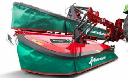
En caso de un obstáculo, la segadora se mueve hacia atrás y luego se levanta, incluso en la parte interior de la segadora, y luego regresa a la posición de trabajo una vez que se ha pasado el obstáculo.
