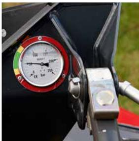
La presión sobre el suelo de la serie 3300 de Kverneland se ajusta fácilmente desde la cabina del conductor, gracias a un dispositivo hidráulico que incluye una escala graduada de fácil lectura.
