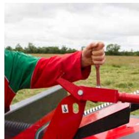
Ajuste de la altura de corte integrado en la suspensión.
