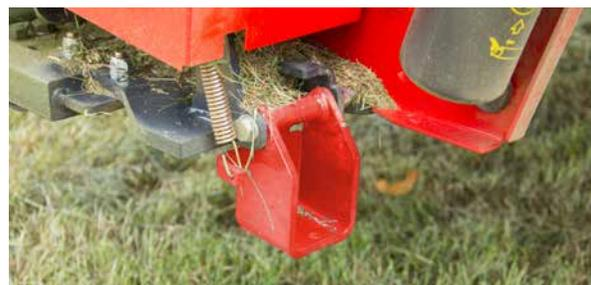
El soporte de estacionamiento se activa fácilmente y sostiene la segadora perfectamente.
