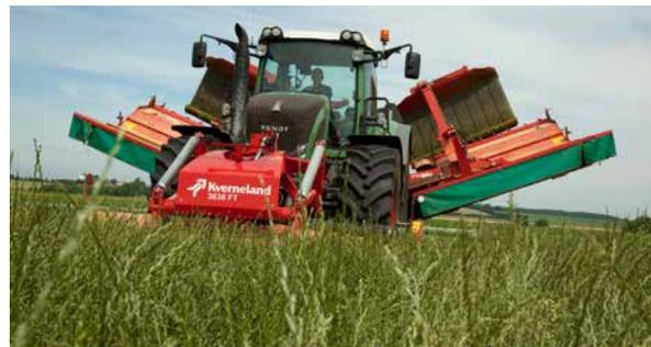
A pesar de su tamaño, la Kverneland 5090 MT es fácil de maniobrar en la cabecera. Cada unidad de corte puede ser levantada presionando un solo botón de la caja de cambios.
