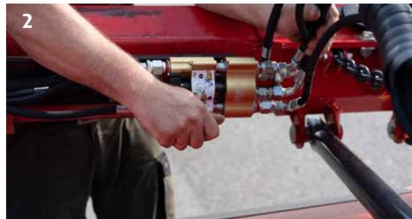
2 Desconecte el cable de alimentación y todas las conexiones hidráulicas de la cinta BX con una sola palanca.
