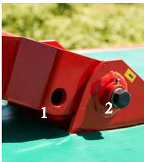
Dos posiciones de montaje de la barra de corte para un solapamiento óptimo.
