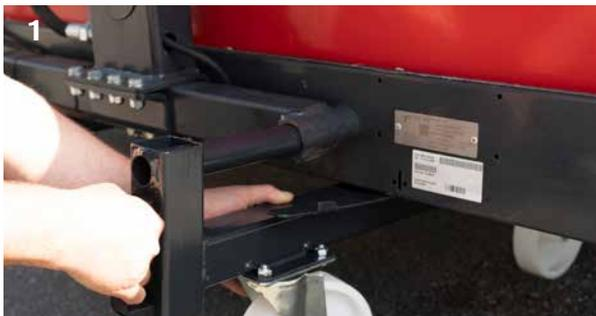
1 Deslice las ruedas de transporte suministradas en la cinta BX y retire el pasador de conexión.
