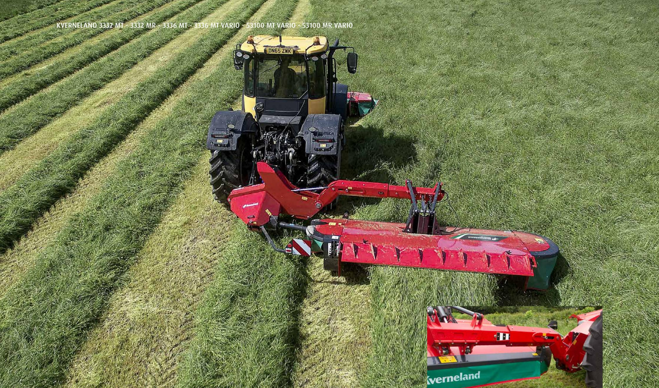
El solapamiento y la anchura de trabajo se ajustan hidráulicamente en los modelos Vario.
