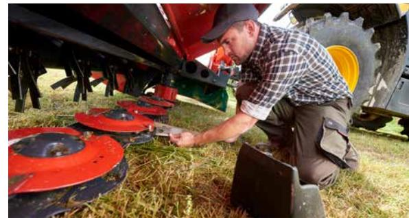
Acceso rápido y fácil a la barra de corte para la inspección diaria de los discos y cuchillas.
