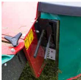
Doble ajuste de la placa de acondicionamiento.
