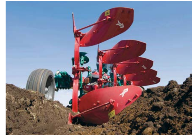
Furcheprofil Körper Nr. 28 Arbeitstiefe: 26 cm, Sohle: 30 cm, Breite: 73 cm
