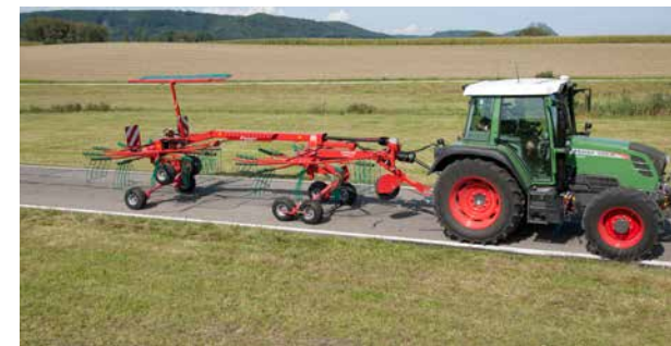
Fjæring på trekkaksel gir bedre kjøreegenskaper og lavere effektbehov.
