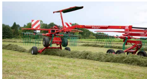
Vending på vendeteiger: Kvernelands maskiner har QuickLift-system som standardutstyr. Det gir en løftehøyde på 50 cm, slik at det er enkelt å krysse eksisterende skårer.
