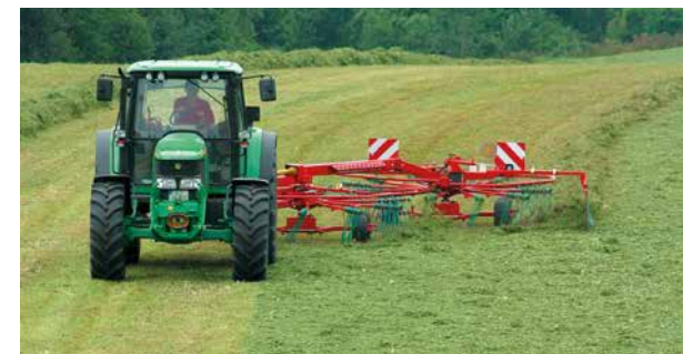
SideShift til venstre – raking uten kjøring på uraket avling.
