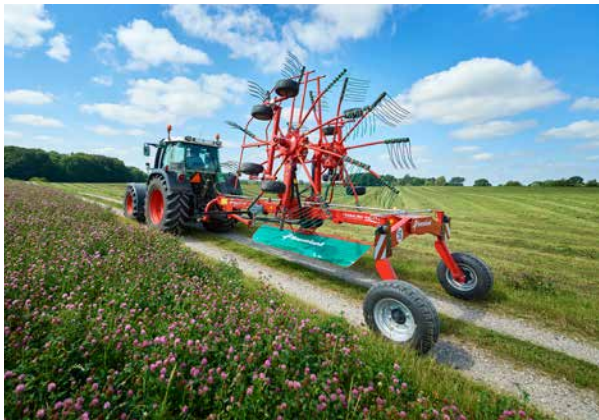
Senterskårrivene konverteres hydraulisk for transport fra traktorhytta.
