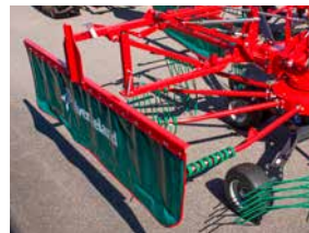
Automatisk sammenleggbart skårbrett med parkeringsstøtte.
