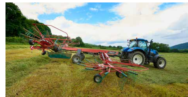
Individuell parvis løfting av de fremre og bakre rotorene. Justerbar tidsforsinkelse for vendeteigstilling er standard.
