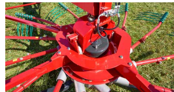
Hver rotor kan stilles inn uavhengig og hydraulisk for høyde.
