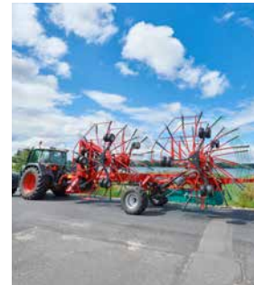
Transporthøyde under 4,0 m, selv uten demontering av tindearmene.
