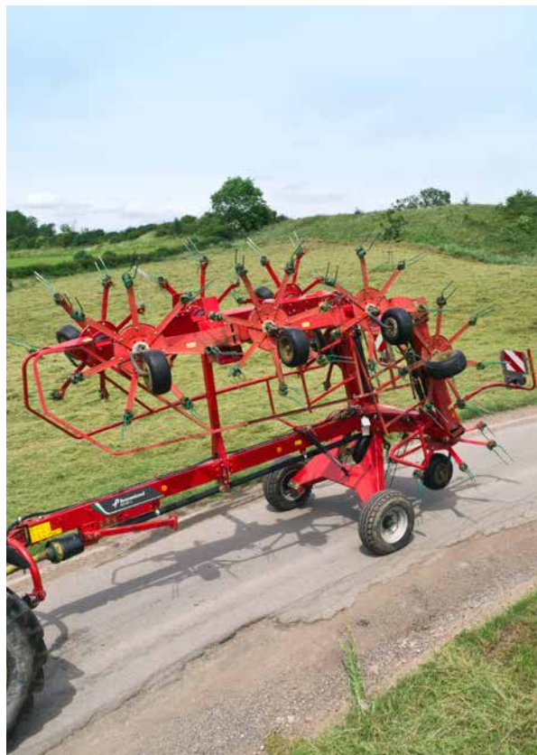
Vanderen har en transporthøjde på kun 3,35 m og en transportbredde på under 3,00 m.
