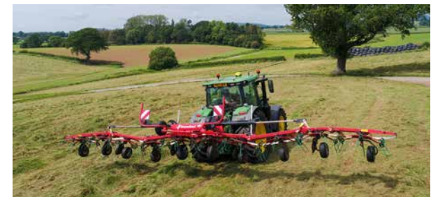
Det hydrauliske foragersystem (ekstraudstyr) stabiliserer uden besvær venderen under vendinger i foragre.
