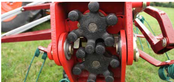
Kverneland 85112 er udstyret med den nye XL-version af Hexa-Link fingerkoblingen. Den giver en driftssikker trækraftoverførsel og mulighed for at folde rotorerne 180 grader for transport.
