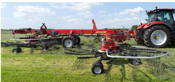
La hauteur de travail de chaque rotor peut être réglée indépendamment et hydrauliquement.
