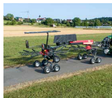
Les essieux tirés garantissent une maniabilité fluide et une faible contrainte sur le châssis, tant sur route que dans les champs.
