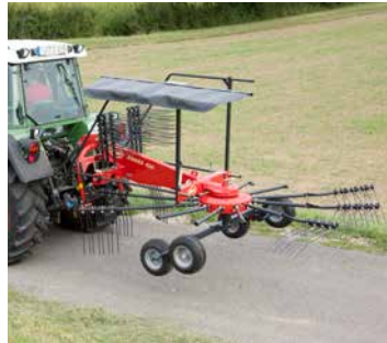
Tous les andaineurs peuvent être adaptés pour réduire la largeur de transport et de stockage en retirant les bras porte-dents et en les plaçant sur le châssis porteur.
