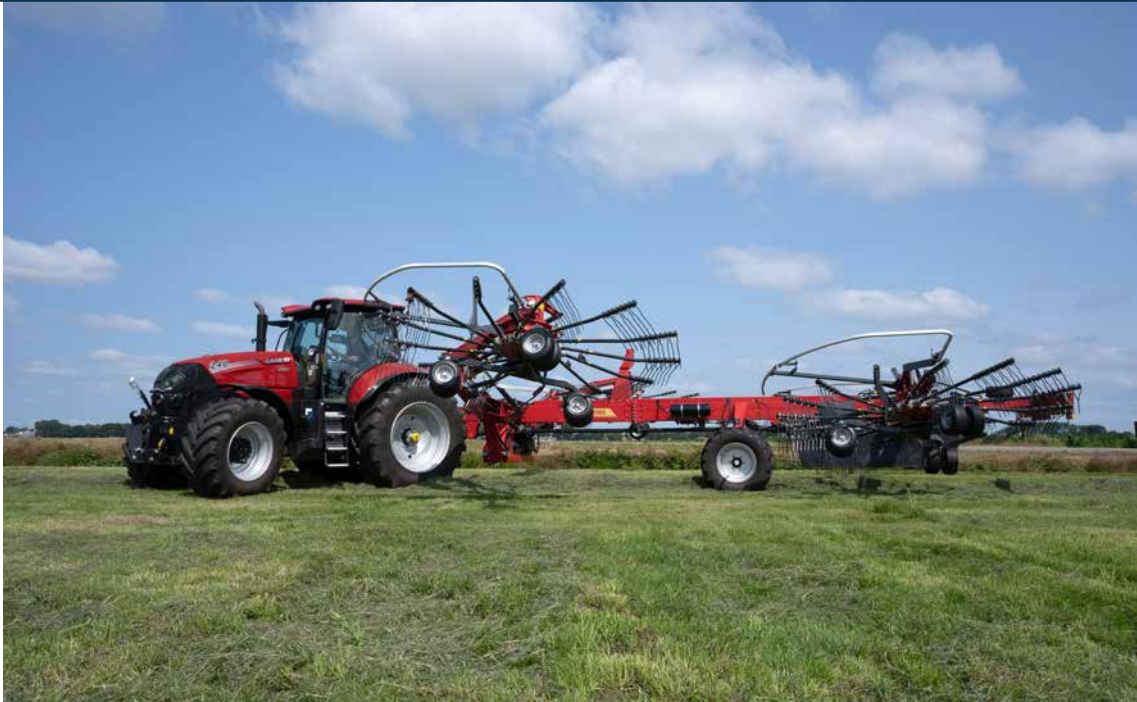
Les 4 rotors peuvent être soulevés individuellement.
