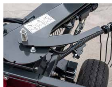
Levier pour sélectionner le placement de l'andain et activer l'arrêt en position centrale.
