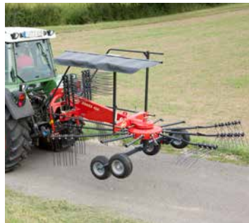
Tous les andeneurs peuvent être adaptés pour réduire la largeur de transport et de stockage en retirant les bras porte-dents et en les plaçant sur le châssis porteur.
