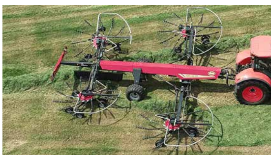
Vicon Andex 1304 Pro Relevage individuel des rotors.
