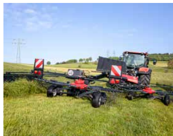
Déplacement latéral vers la droite - nettoyage facile des bordures avec une vue parfaite sur le rotor.
