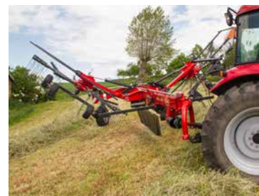
Essieu auto-directionnel pour des virages serrés jusqu'à 80°.
