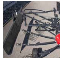
Repliage automatique de la planche à andains et béquille de stationnement.
