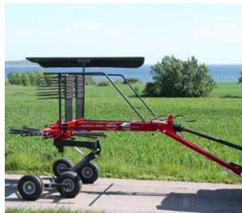
Avec un timon, l'Andex 474T peut facilement être utilisé avec des tracteurs de faible puissance.
