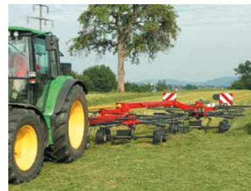
SideShift vers la gauche - pour andainer sans rouler sur des cultures non ramassées.
