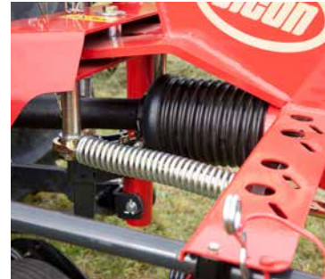
Une tête d'attelage pivotante à 3 pts assure un parfait suivi du terrain et des manoeuvres aisées en fourrière. Des amortisseurs d'oscillations sont disponibles en option.
