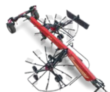
Andex 705 Evo/Vario Largeur de travail de 7 à 9 m Andex 714T Evo/Vario Largeur de travail de 6,6 à 7,1 m
