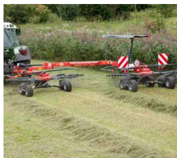
Les deux andaineurs sont capables de former de petits andains pour la paille.
