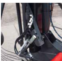
Verrouillage hydraulique au transport (option).
