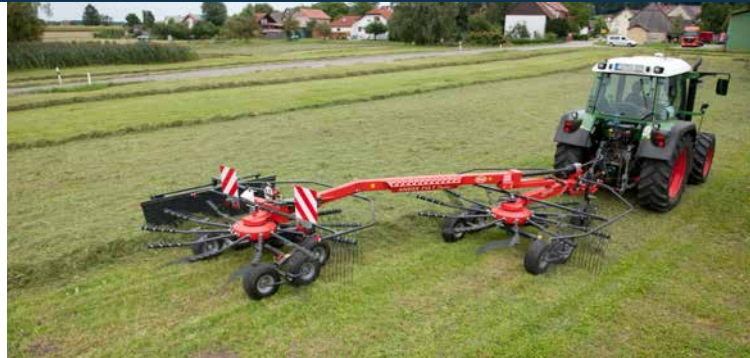
Le 714T VARIO : 7,10 m de largeur de travail et système SideShift.
