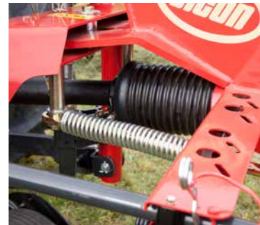
Une tête d'attelage pivotante à 3 pts assure un parfait suivi du terrain et des manœuvres aisées en fourrière. Des amortisseurs d'oscillations sont disponibles en option.
