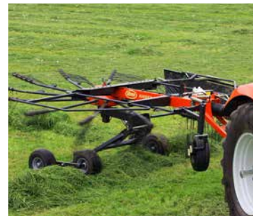
La machine peut être relevée de 50 cm, facilement, depuis la cabine du tracteur.
