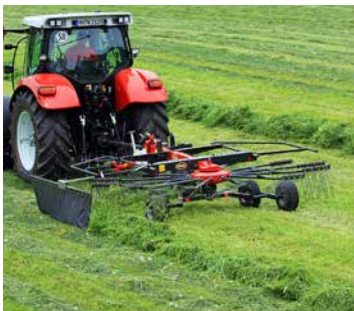
Andex 474T - largeur de travail de 4,70 m et un poids de seulement 665 kg.
