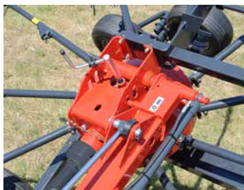
L'ajustement hydraulique des rotors permet un réglage de 7,00 m...
