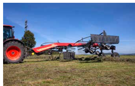
Dégagement par rapport au sol de 500 mm.
