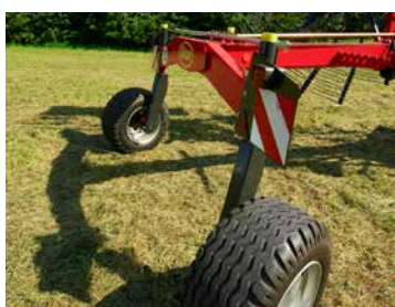
Equippé en standard d'un essieu auto-directionnel pour une manœuvrabilité exceptionnelle.
