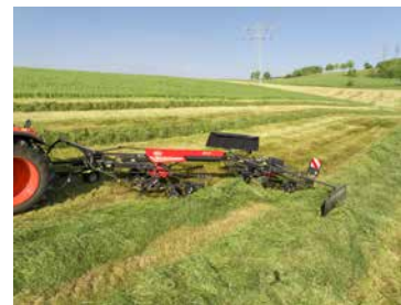
Déplacement latéral vers la gauche - ramassage sans rouler sur la récolte.
