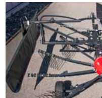
Repliage automatique de la planche à andain et béquille de stationnement.
