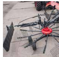
Repliage automatique de la planche à andain et béquille de stationnement.
