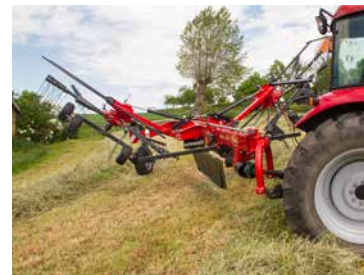
Essieu auto-directionnel pour des virages serrés jusqu'à 80°.
