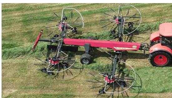
Vicon An dex 1304 Pro Relevage individuel des rotors.
