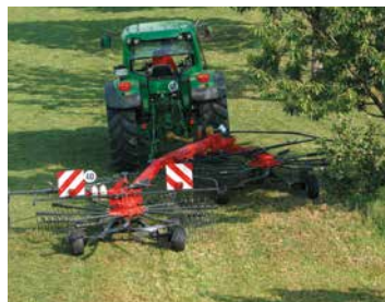
SideShift vers la droite - pour passer facilement autour des arbres.
