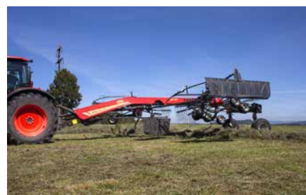
Dégagement par rapport au sol de 500 mm.
