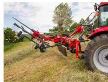
Essieu auto directionnel pour des virages serrés jusqu'à 80°.
