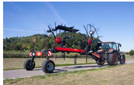
Hauteur au transport inférieure à 4 m.
