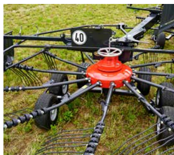
Réglage facile de la hauteur du rotor arrière.
