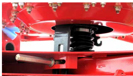
Vicon Andex 1304 Réglage de la levée de came.
