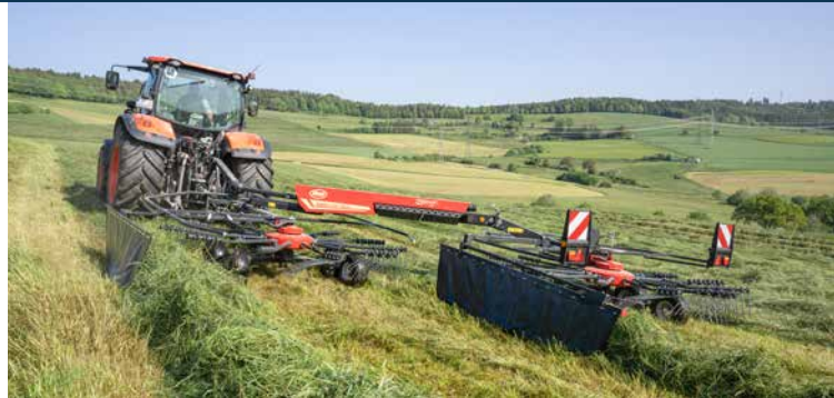
Le 715T Vario avec une largeur de travail de 7,10 m en position double andain.
