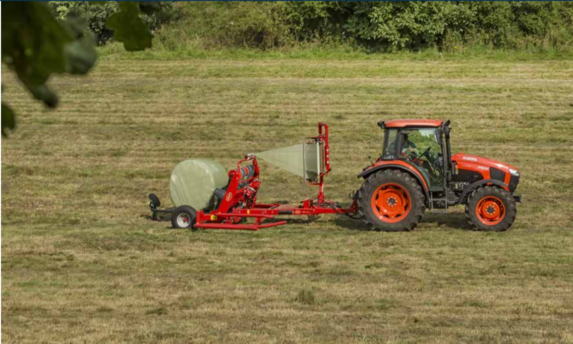
Le bras de chargement est complètement abaissé pour soulever la roue du sol et faciliter le passage du travail au transport.
