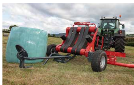
Les enrubanneuses à table tournante Vicon peuvent être équipées d'un kit de déchargement vertical.
