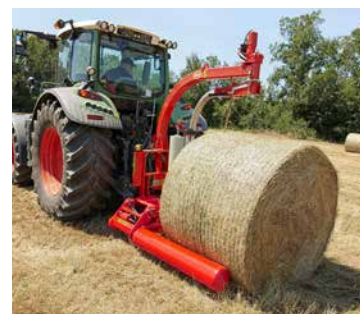
La table d'enrubannage se déplace rapidement vers les pré-étireurs et l'enrubannage commence instantanément.
