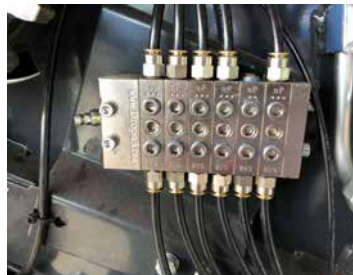
Banque de graisse centralisée pour les roulements de la chambre de pressage.
