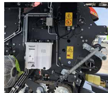
Tubes rigides en acier pour le circuit hydraulique.
