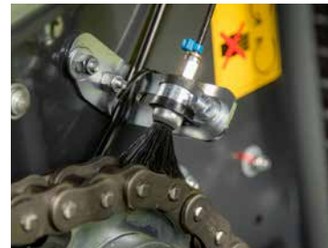
La lubrification automatique des chaînes est en standard sur la FixBale 500.
