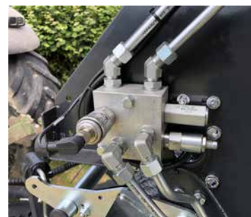
Contrôle électronique de la densité des balles.
