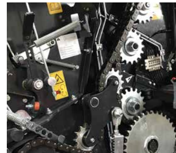
Des chaînes 1¼" de spécification HBC sont utilisées pour l'entraînement de la chambre de pressage et du rotor.
