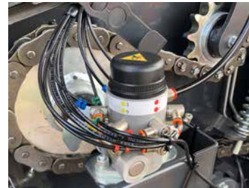
Lubrification automatique des chaînes avec des sorties réglables indépendamment.
