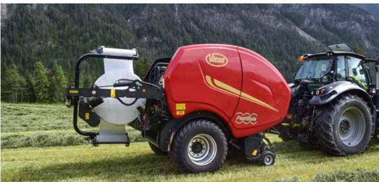
Le système d'enrubannage innove en matière de compacité. Pendant le transport, le rouleau arrière et les satellites sont repliés en position verticale, ce qui réduit considérablement la longueur totale, tandis que tous les éléments d'emballage sont à l'abri de toute obstruction. Les rouleaux de film sont également protégés pendant le transport par les bras satellites. L'oscillation minimale de la queue permet un accès facile aux champs et dans les passages plus étroits.
