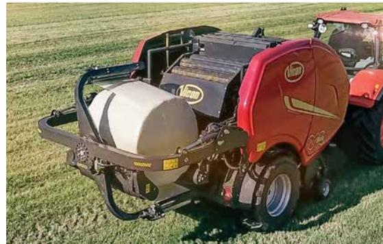
Lorsque la base est positionnée sur la table d'enrubannage, celle-ci est relevée permettant aux satellites d'entrer en action.
