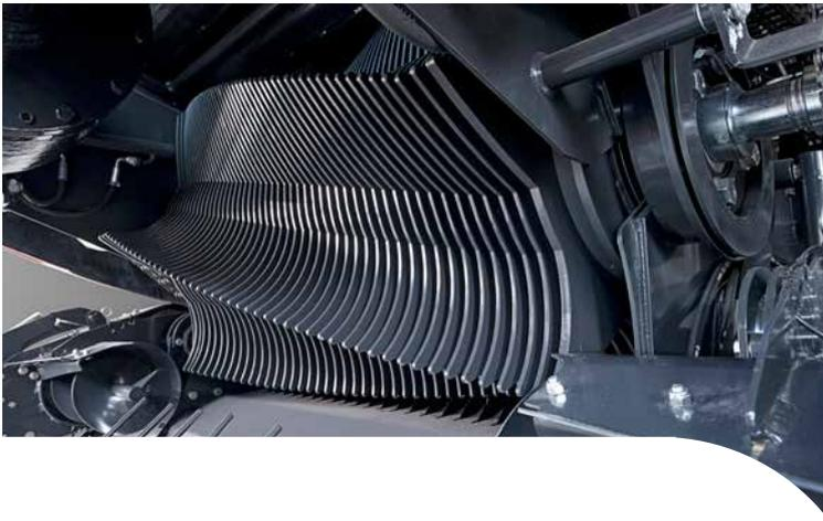
Équipé de 50 dents en Hardox®, le FastBale a une capacité inégalée. La position du pick-up par rapport au rotor élimine les zones mortes lorsque vous travaillez sur des fourrages courts.
