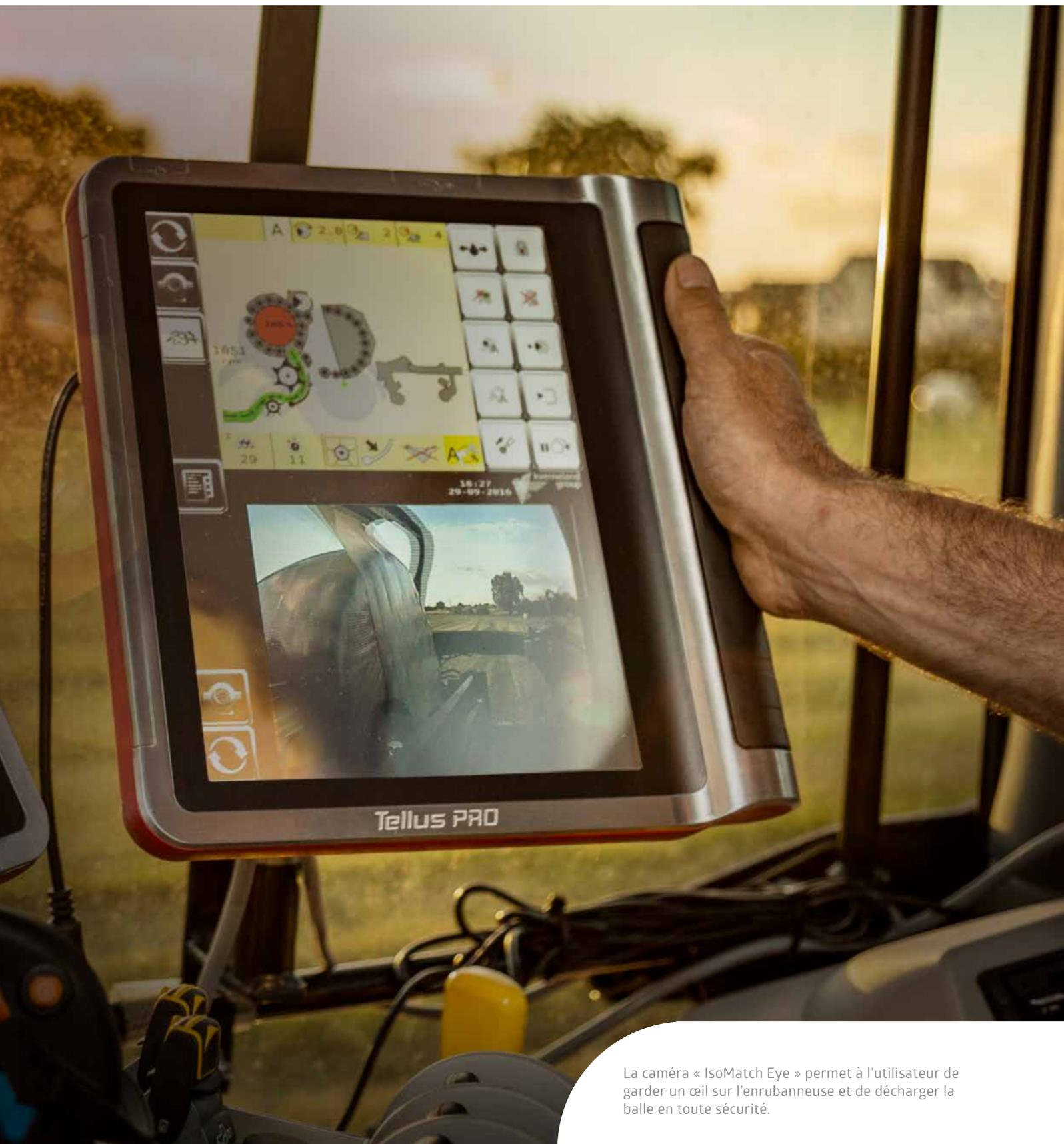
La caméra « IsoMatch Eye » permet à l'utilisateur de garder un œil sur l'enrubanneuse et de décharger la balle en toute sécurité.
