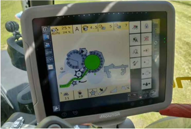
Le FastBale est 100% compatible ISOBUS en standard et peut être équipé sur n'importe quel tracteur ISOBUS, sans l'ajout d'un boîtier supplémentaire.
