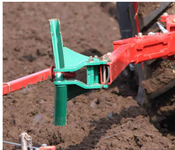
Sammenkobling mellem fangarm og slæbepakker
