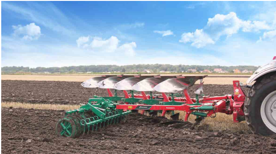
Packomat jordpakkeren fås til Kverneland 2500 i-Plough med op til 5 furer
