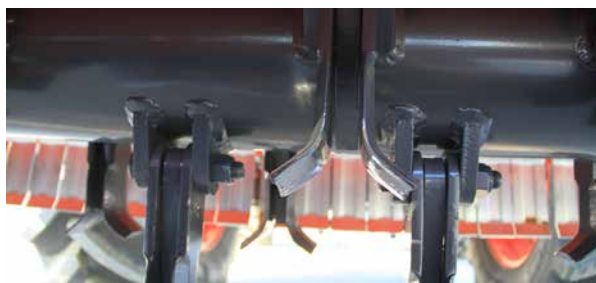
Le rotor du FXE peut être équipé de lames Y ou de marteaux. Les patins latéraux sont montés de série.
