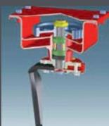
Бороны Kverneland рассчитаны для работы в тяжелых условиях с тракторами до 350 л.с. Особое внимание уделяется надежности и прочности конструкции. Это достигается за счет большого расстояния между коническими подшипниками, закаленными рабочими органами и сверхпрочной конструкции.
