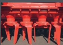
Стойки расположены в разных углах, чтобы предотвратить повреждение камнями и обеспечить ровное выравнивание. Это также уменьшает пиковые нагрузки на трансмиссию и приводит к более плавной работе и уменьшает расход топлива.
