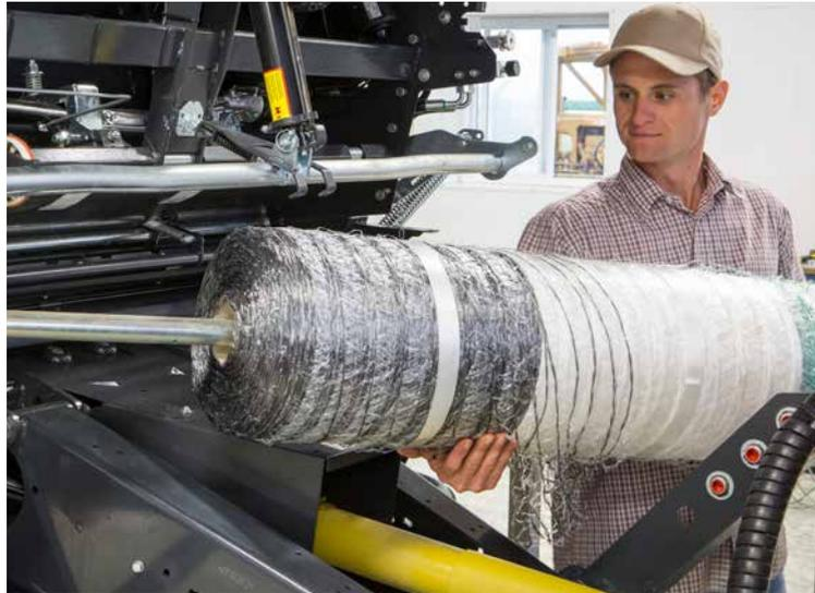
La hauteur de chargement très basse et le système très simple de liage permettent des temps d'arrêt plus courts et laissent plus de temps à la formation de balle.
