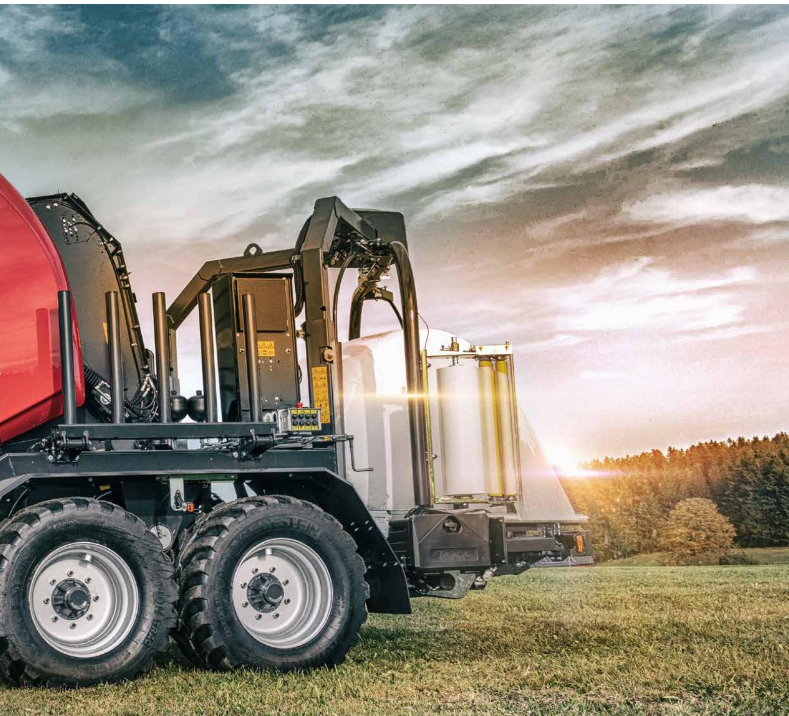
La solution optimale pour le pressage et l'enrubannage combiné, garantie d'un travail rapide et efficace. Diamètre de balle maximum jusqu'à 1,65 m pour la RV 5216 et jusqu'à 2 m pour le RV 5220 (pressage uniquement). Un choix de systèmes d'alimentation à rotor de coupe SuperCut à 14 ou 25 couteaux.
