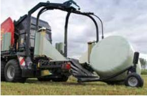
Option vire balle. Pendant le transport, le kit est automatiquement pivoté en position de sécurité sur l'enrubanneuse.
