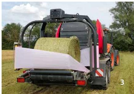
Aussitôt la balle sortie de la presse, le hayon se referme automatiquement et la formation de balle peut reprendre.
