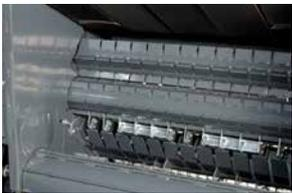
Des rouleaux profilés offrent une formation de balle instantanée et sont équipés de racloirs autonettoyants conçus pour fonctionner dans des conditions d'ensilage humide.
