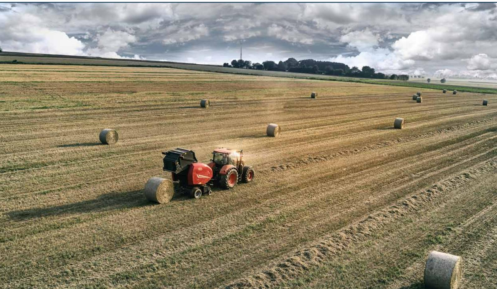
Avec une presse RV Vicon, votre champ sera rempli de balles parfaitement formées. Les systèmes de liage ficelle et filet PowerBind de Vicon permettent de réaliser des balles nettes et bien serrées.
