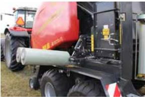
Stockage de 10 rouleaux de film de rechange abaissé hydrauliquement.
