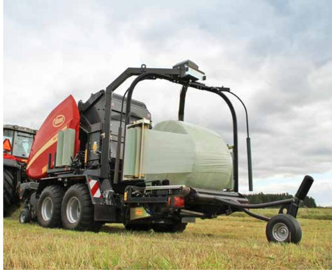
Enrubanneuse double satellite munie de 2 pré-étireurs et de 4 courroies sans fin pour un enrubannage rapide et régulier.
