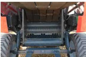
Un ensemble de cinq courroies et trois rouleaux permettent d'obtenir des balles denses avec un cœur tendre et un démarrage de balle facile.
