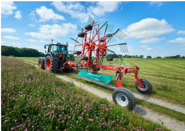
Los hileradores centrales se convierten hidráulicamente para el transporte desde la cabina del tractor.
