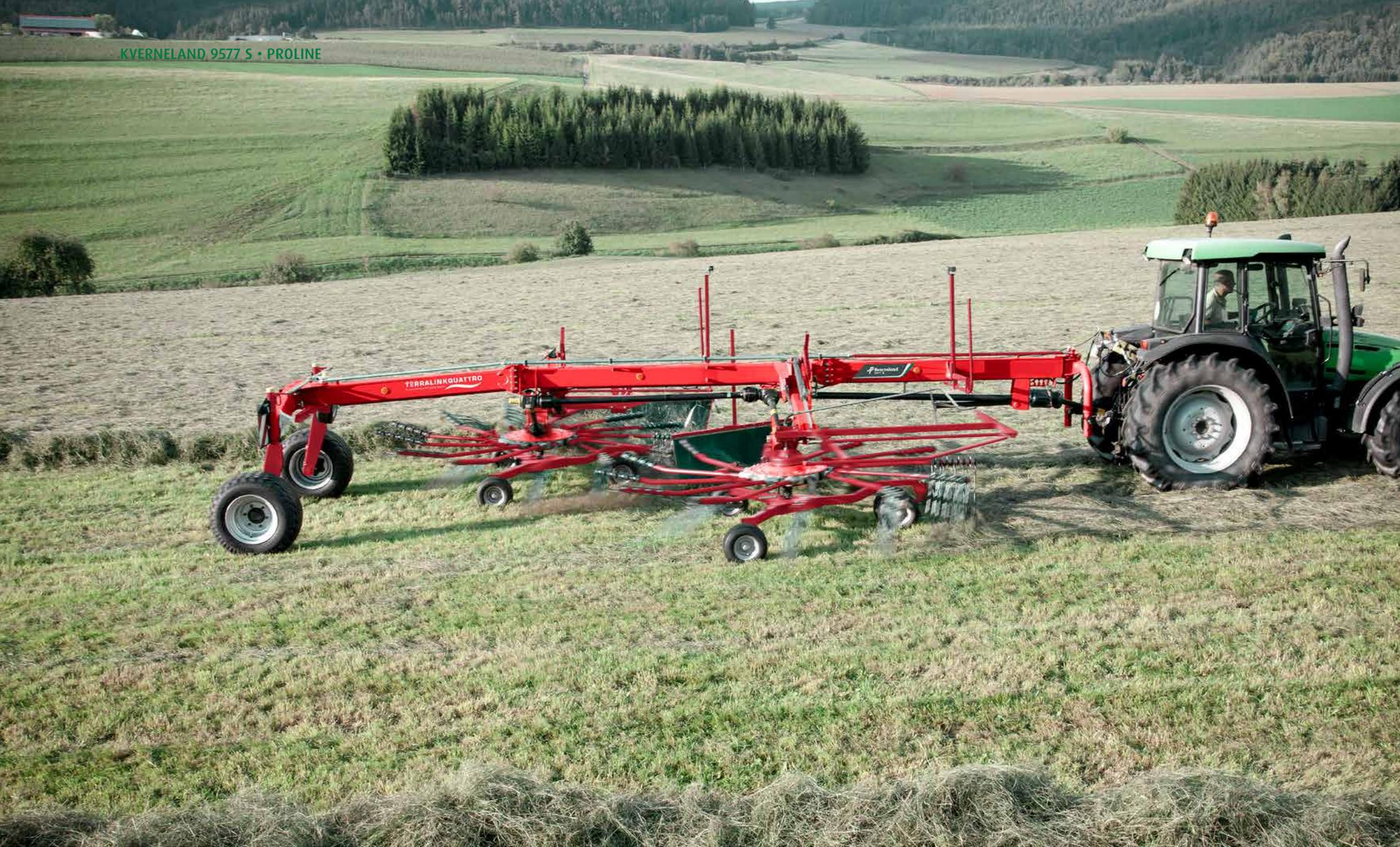
El concepto de hilerado lateral permite recoger la cosecha desde 15.00m en una sola hilera.
