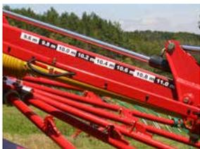
El ancho de trabajo se puede ajustar hidráulicamente de 9,30 m a 10,60 m.
