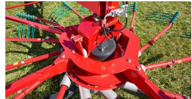
La altura de trabajo de cada rotor se puede ajustar de forma independiente e hidráulica.
