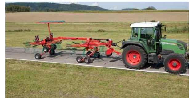
El eje trasero suspendido proporciona un excelente confort de conducción y reduce las necesidades de potencia.
