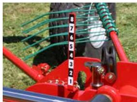
Ajuste hidráulico de la altura de los rotos según la longitud de las hileras o las condiciones del suelo.
