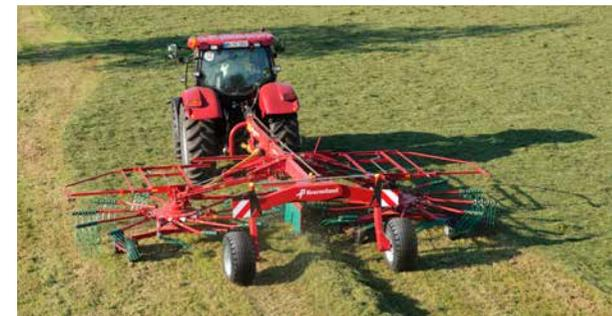
El Kverneland 9584 C con una anchura de trabajo de 8,40 m, un grupo totalmente cerrado y una anchura de trabajo ajustable hidráulicamente.
