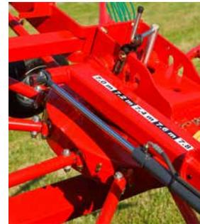
9476 C - Ancho de trabajo hidráulico 7,0-7,8 m.
