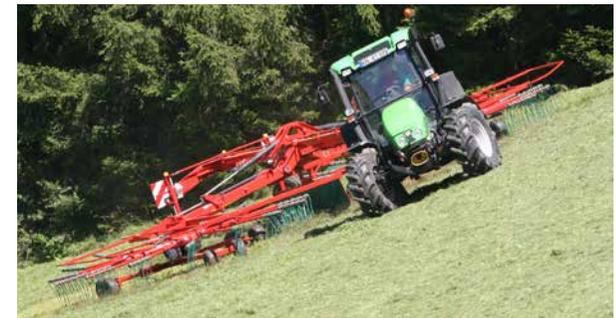
Las ruedas direccionales reducen los radios de giro y facilitan las maniobras.
