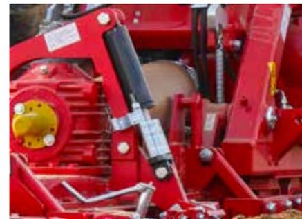
Гидравлически складывающиеся роторные бороны имеют гидравлическую настройку рабочей глубины. Регулировка происходит при помощи накидных колец. Параллелограммная навеска катка является большим преимуществом при агрегатировании с сеялками.
