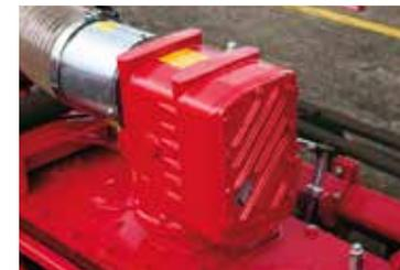
Гидравлически складываемые роторные бороны оснащены центральным редуктором и двумя боковыми редукторами. Скорость вращения роторов может настраиваться от 336 до 450 об/мин при скорости ВОМ 1000 об/мин.
