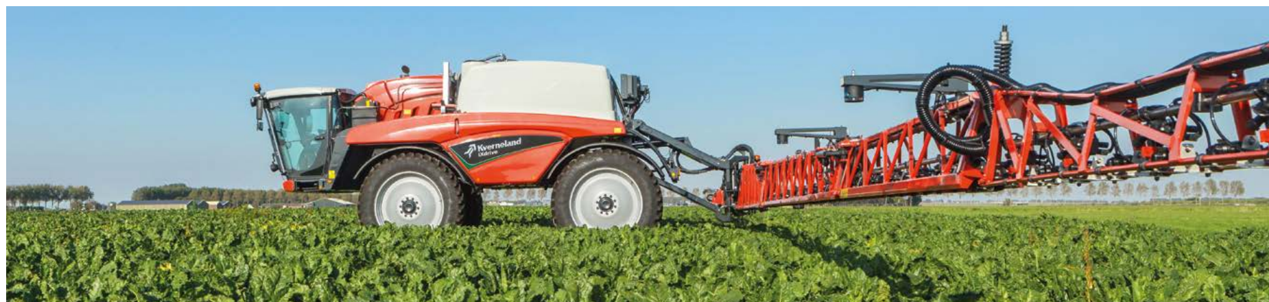
Boom Guide ProActive může využít 3 senzory při symetricky redukovaném záběru
