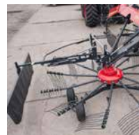
Automatikusan lenyíló rendterelő ponyva kiemeléssel.
