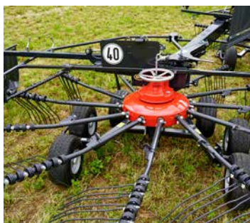
A rotor magasságának egyszerű beállítása hátul.
