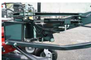
A TerraLink Plus biztosítja a rotor egyenletes mozgását és a pontos talajkövetést az optimális rendképzés érdekében.
