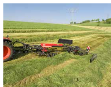
Oldalirányú eltolás balra – rendképzés a terményre hajtás nélkül.
