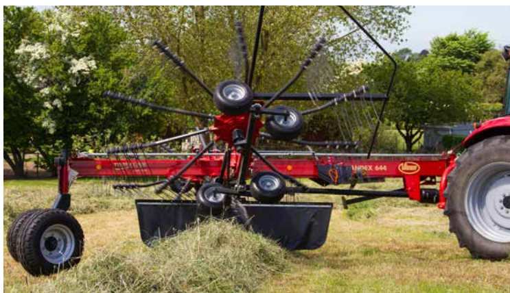
A rotortartó kiemelési magassága, elég helyet biztosít a fordulóban.
