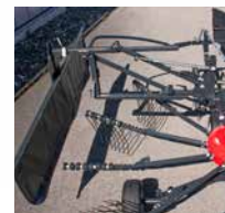
Automatikusan lenyíló rendterelő ponyva kiemeléssel.
