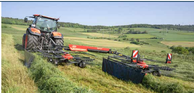
A 715T Vario 7,10 méteres munkaszélességgel, két rendképzési üzemmódban.
