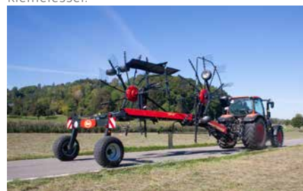
Szállítási magasság 4m alatt.
