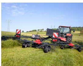
Oldalirányú eltolás jobbra – a tábla szélek felsodrása, tökéletes rálátással a rotorra.
