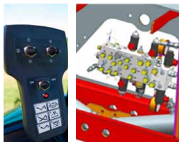
Eenzijdig heffen van de voorste rotoren
