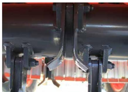
Le rotor du Bromex CJ peut être équipé de lames Y ou de marteaux. Les patins latéraux sont montés de série.
