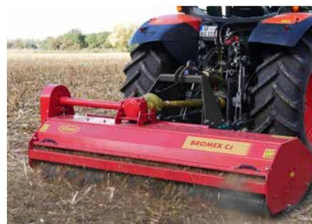
Le Bromex CJ peut être équipé d'un rouleau arrière (195 mm de diamètre) ou 2 roues semi-pivotantes (155 SR13) pour un contrôle parfait de la hauteur de coupe.
