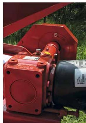
Tous les boîtiers d'entraînements sont équipés en série d'une roue libre intégrée. Le Bromex PA est équipé de série d'un rouleau arrière qui permet un contrôle précis de la hauteur de coupe.
