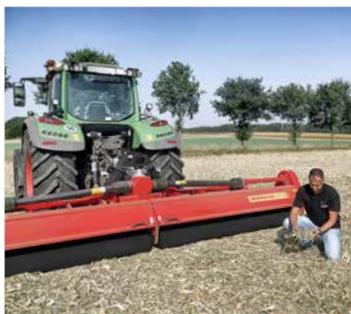
Largeur de travail de 5,60 à 6,40 m. Le rouleau standard (Ø245mm) est placé à proximité de la caisse pour assurer un effet autonettoyant.
