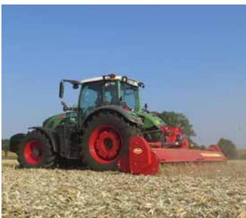
Le boîtier d'entraînement (250 CV) est équipé d'une roue libre ; la transmission latérale avec tendeurs automatiques de courroies assure une grande fiabilité et une maintenance réduite.
