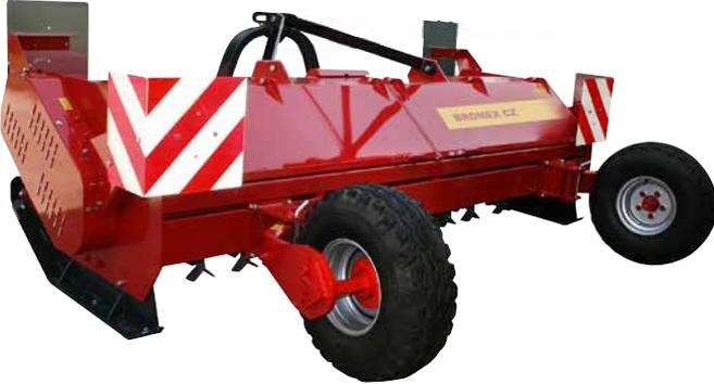
Roues pivotantes (10/8.0 x 12.8 ply) en standard garantissent la stabilité et contrôlent la hauteur tout au long du broyage.
