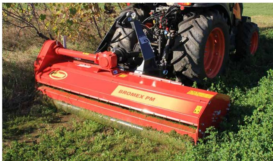
Un rouleau arrière Ø 160 mm avec barre décrottoir réglable en équipement standard. Un décrottoir réglable assure une qualité de travail parfaite sur le terrain.
