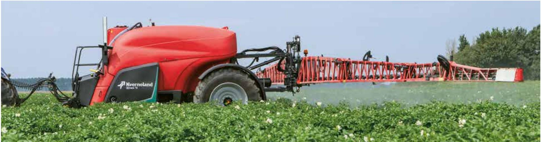
La barra HSS combina un peso ridotto con la massima resistenza e stabilità. L'acciaio speciale Domex, con cui è prodotta, la rende adatta agli usi più intensi e ad un'elevata longevità. Le connessioni in alluminio, piuttosto che le saldature, permettono di ridurre il peso e aumentare la resistenza.
