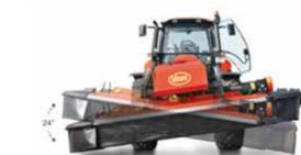
Il design tridimensionale flottante, con adattamento trasversale a 24°, garantisce di seguire il terreno in modo eccezionale.
