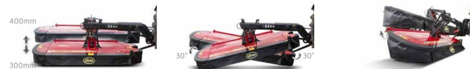
Grazie a questo sistema segue in modo eccezionale il profilo del terreno. I quattro bracci di sospensione forniscono un raggio d'azione di 400 mm verso l'alto e di 300 mm verso il basso per seguire in modo accurato il terreno.
