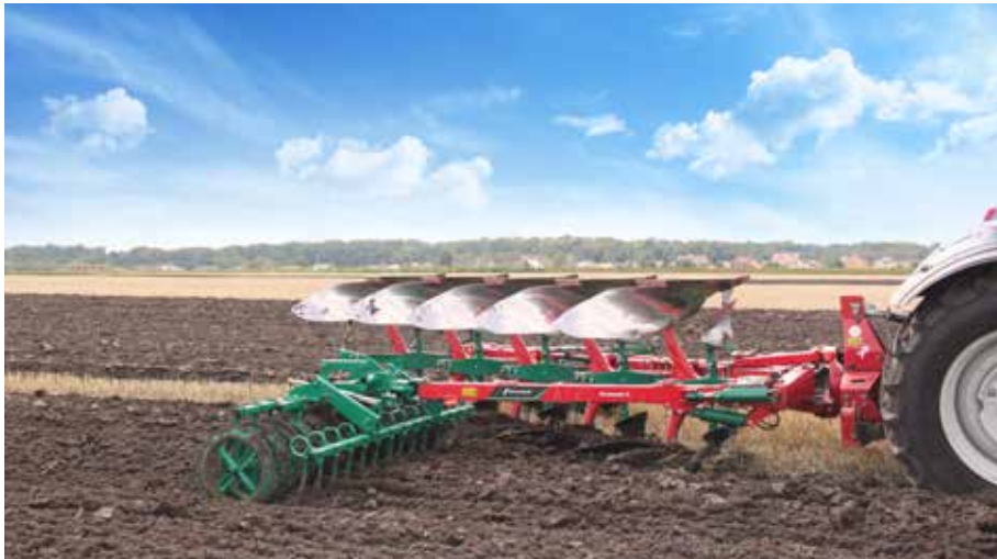
Il Packomat è disponibile per gli aratri Kverneland i-Plough 2501 fino a 5 corpi.
