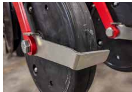
Para suelos muy pegajosos se puede equipar la rueda con un rascador (variante).
