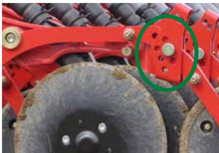
Rueda de consolidación posición fija
