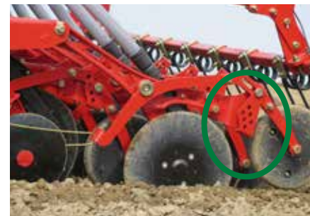
Rueda de consolidación levantada
