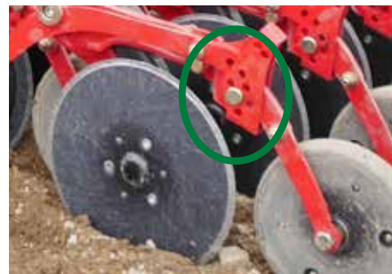
Rueda de consolidación posición flexible
