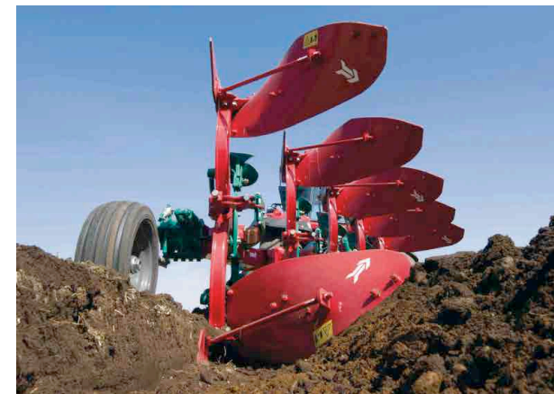
Profiel rister Nr. 38 'EvoTwist' werkdiepte: 26 cm, maximum: 30 cm, breedte 73 cm
