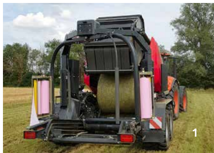
Zodra het net op de baal is aangebracht, beweegt de wikkeltafel naar voren onder de achterklep van de pers.
