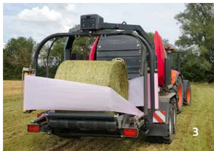
Zodra de baal is weggevoerd van de perskamer sluit de achterklep automatisch, en kan het persen hervat worden.
