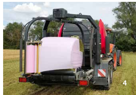
De wikkeltafel beweegt snel naar de voorspanners en het wikkelen begint onmiddellijk.
