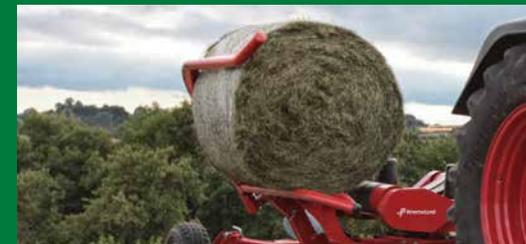
Зажимочный рычаг с гидравлическим приводом и низкая высота загрузки обеспечивают быструю передачу тюка с рычага на поворотный стол.
