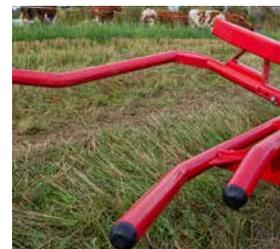
Регулируемый погрузочный рычаг позволяет поднимать и загружать тюк на ходу.
