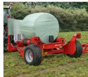
Конструкция низкоустановленного стола обеспечивает высокую скорость вращения.
