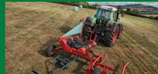
Поворотный стол с двумя приводными роликами предназначен для обеспечения высокой устойчивости тюков и плавного равномерного вращения.
