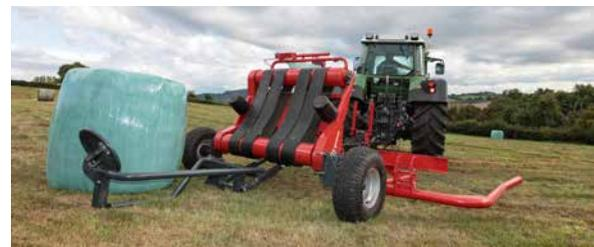
Обмотчики с поворотным столом Kverneland могут оснащаться комплектом для оборота тюков на торец.
