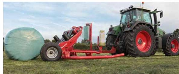
Низкая конструкция машины обеспечивает быструю и бережную выгрузку тюка.
