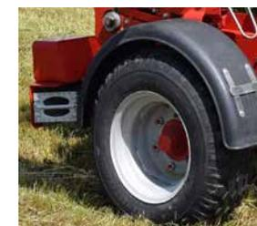
Брызговики уменьшают скопление грязи на подрамнике и рулонах пленки при работе на мягком грунте и во время транспортировки.
