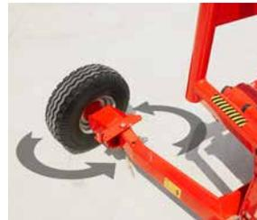
Для уменьшения ширины транспортировки правое колесо поворачивается внутрь опорного рычага.
