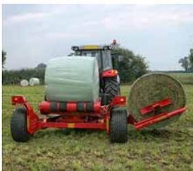
Небольшая высота подъема обеспечивает быструю передачу тюка с рычага на поворотный стол.
