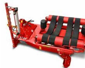
Версия 7710 С с блоком управления и радиочастотным пультом дистанционного управления обеспечивает полностью автоматическую работу.
