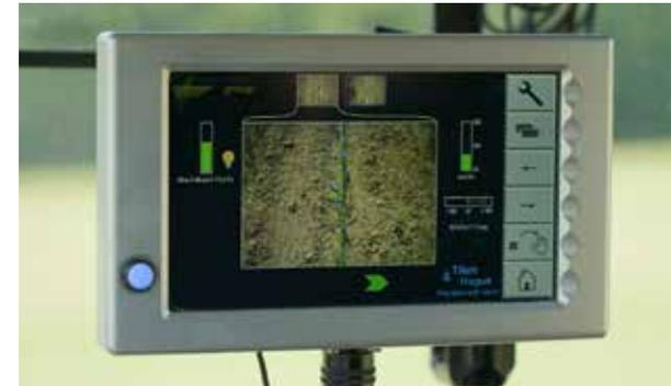
Das Terminal verfügt über einen hellen, kontrastreichen 9-Zoll-Touchscreen, er ist wasserdicht und kann mit einer oder zwei Kameras und einem Reihentaster arbeiten. Das Terminal wird verwendet um die Kontur der Reihe, die Kultur, den Reihenabstand und die Farbe der Kultur einzustellen. Der Verschieberahmen Lynx kann auch manuell über das Terminal bedient werden.
