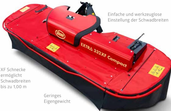
Einfache und werkzeuglose Einstellung der Schwadbreiten
