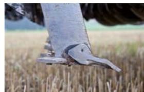
Spezielle Schare mit Flügeln lockern den Boden bis zu einer Tiefe von 30 cm auf. Drei verschiedene Arten von Zinken sind verfügbar.
