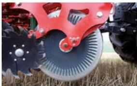
Die Frontschneidscheiben öffnen den Boden und zerschneiden Ernterückstände, die von den folgenden Räumsternen leicht aus der Reihe entfernt werden können.
