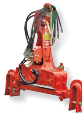
Tête d'attelage N° 200 Conçue pour l'Ecomat. Fusée creuse de 120mm. Fusée forgée et traitée thermiquement. Attelage automatique.
